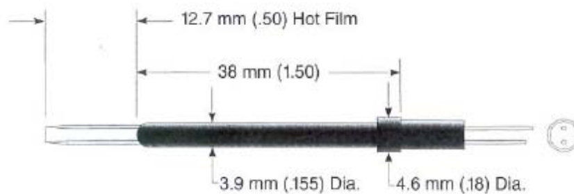
Figure IV.16 : Dimensions du film chaud utilisé dans la présente étude (TSI-Model 1201)
