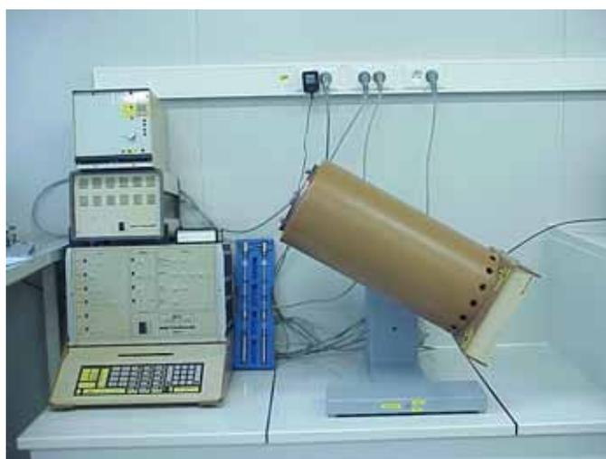
Figure 1.6. Calorimètre C80 SETARAM : Utilisation de la cellule de retournement (LSPC, INERIS 2005)
