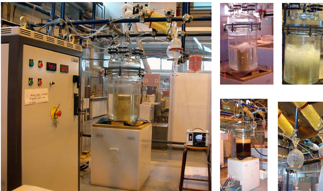
Figure II.3.1.2.2.1-2 Système de distillation par ITMD pendant l'échauffement et l'extraction des huiles essentielles. Côté droit, en haut (lors de l'échauffement de solution conductrice), en bas à gauche (pendant l'hydrodistillation de graines de carvi) et à droite (mesure de température de condensation des distillats).
