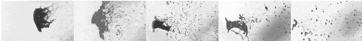
FIG. 1.9 – Atomisation par cisaillement, Samenfink [62]
