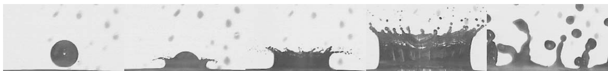
FIG. 1.11 – Atomisation par éclaboussement, Samenfink [62]
