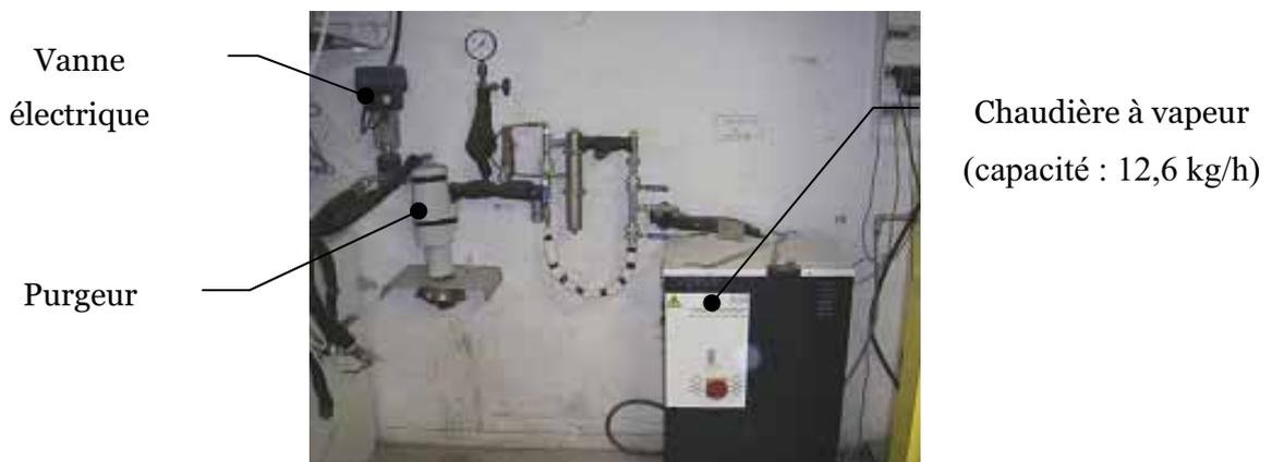
Figure 8. Système de production de vapeur
