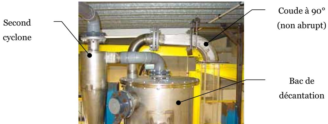
Figure 5. Sortie du riser, entrée du bac de décantation et second cyclone
