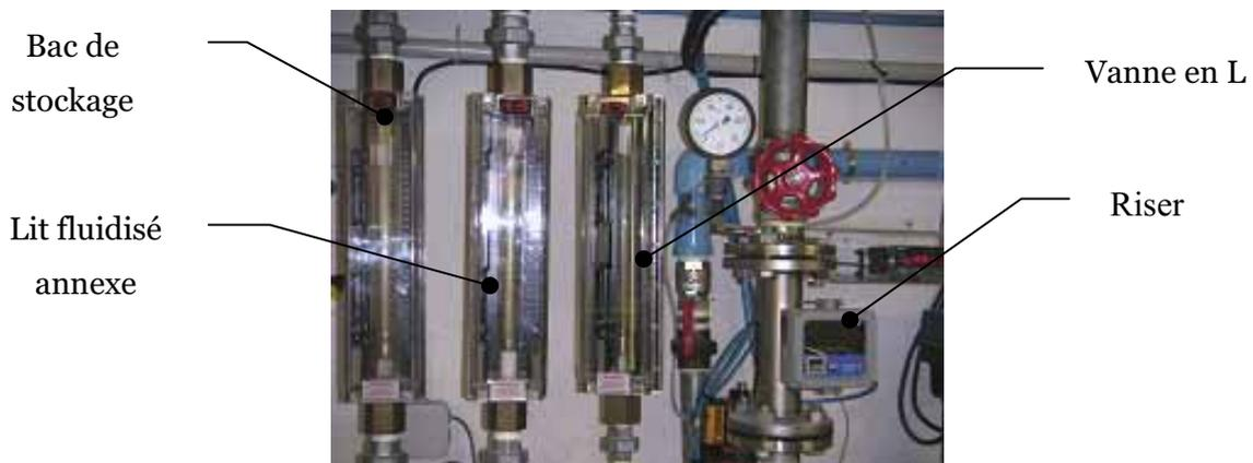
Figure 9. Débitmètres pour la mesure des débits d'air
