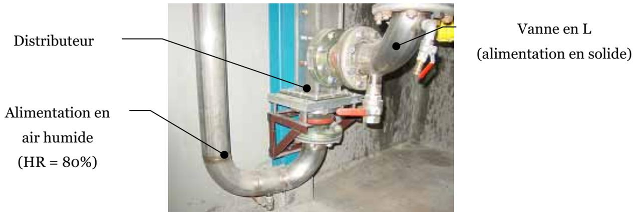
Figure 4. Alimentation du riser en air et en solide
