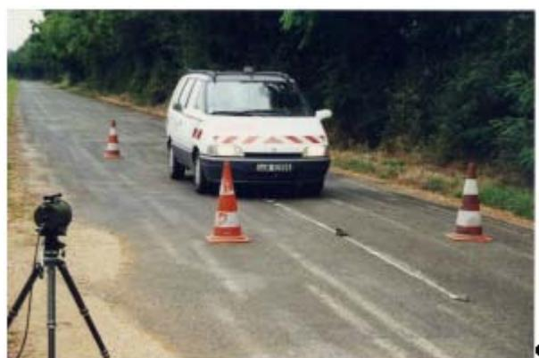
Figure 0.3 Test du principe de dialogue véhicule-infrastructure à base de transpondeurs
