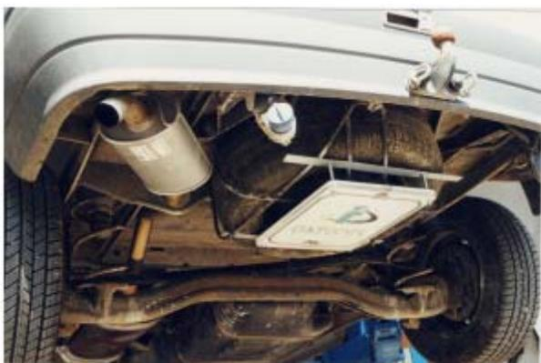
Figure 0.2 Positionnement de l'antenne du lecteur sous le châssis du véhicule de test
