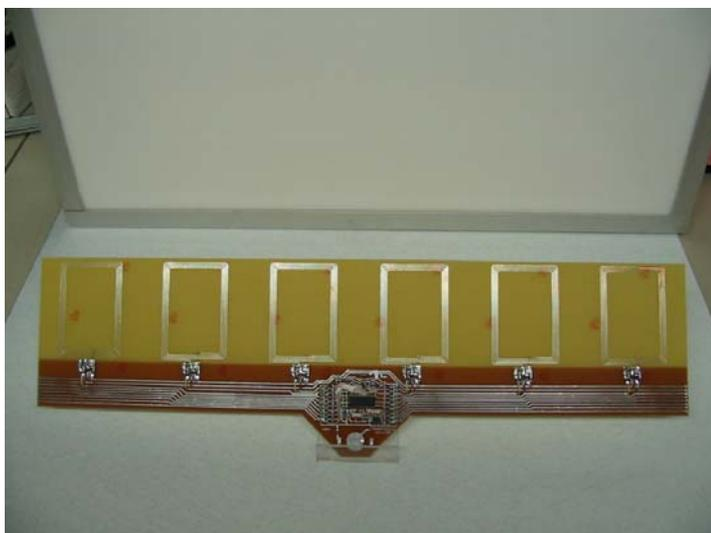
Figure 0.2 Le transpondeur dans sa configuration 6 antennes
