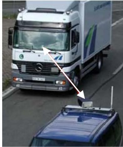
Figure 0.3 Communication IR entre Camion et véhicule [Staudinger 2003a].
