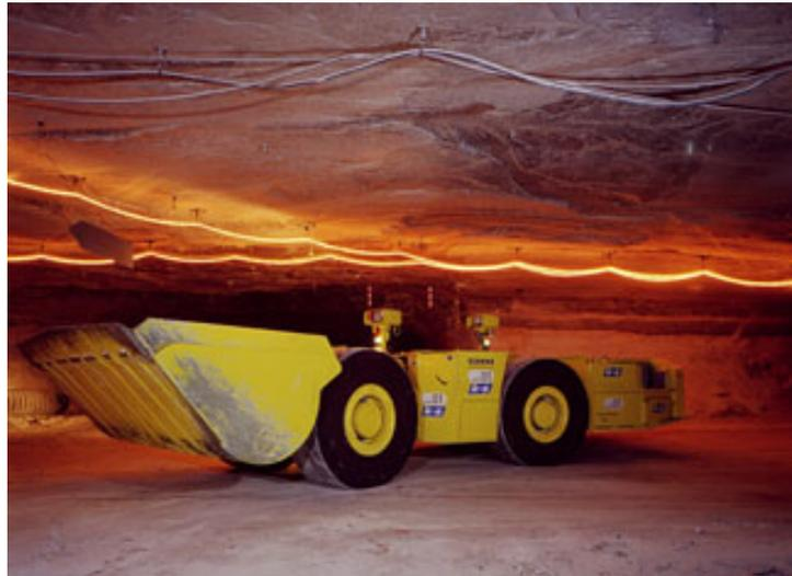
Figure 0.6 Guidage par un fil lumineux d'un véhicule minier de 50 tonnes [Automated Mining].
