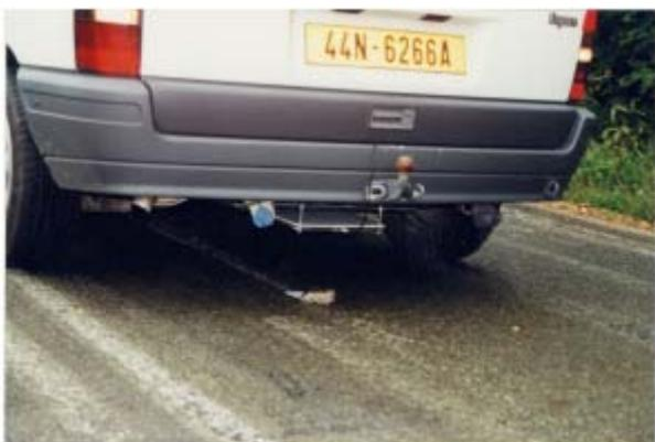
Figure 0.1 Véhicule de test équipé de l'antenne du lecteur
