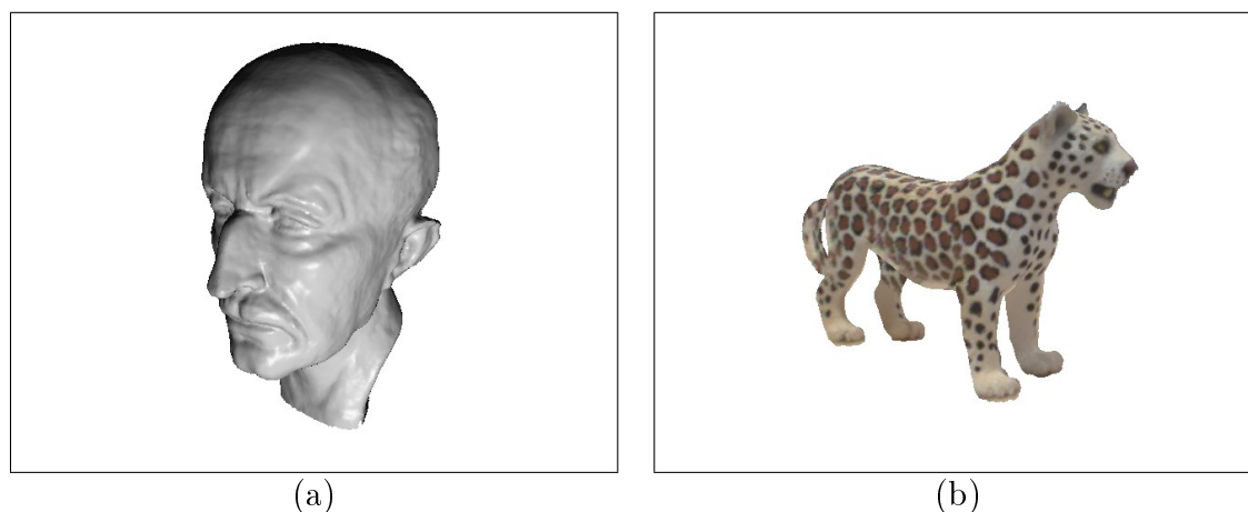
FIG. 4.12 – Exemples de rendu par splats. Dans (a) La couleur de chaque splat est déterminée par un modèle d'éclairage de Phong (à partir d'un matériau de couleur uniforme). Dans (b) la couleur est prédéterminée à partir d'une texture.
