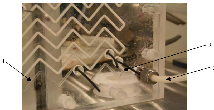
Figure I0-11 : Introduction des deux fluides dans le réacteur Deanhex pour l'encapsulation en continu : 1. Arrivée de la phase continue contenant le monomère HMDA ; 2. Arrivée de l'émulsion, 3. Zone de contact entre l'émulsion et la phase continue contenant le monomère HMDA
