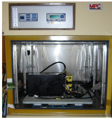
Fig 11. Montage en étuve pour les essais à -40^{\circ}\text{C} et 42^{\circ}\text{C}
