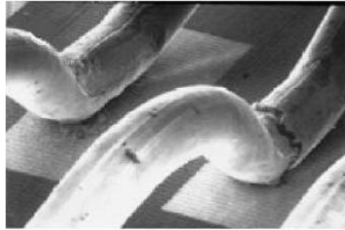
Fig 20. Fissuration au pied d'un fil de bonding [Ciappa, 02]
