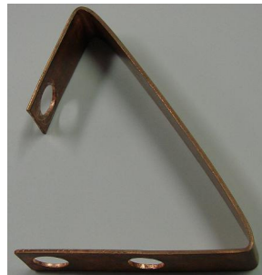
Fig 25. Pâtes de cuivre utilisées pour augmenter l'inductance L_{com}
