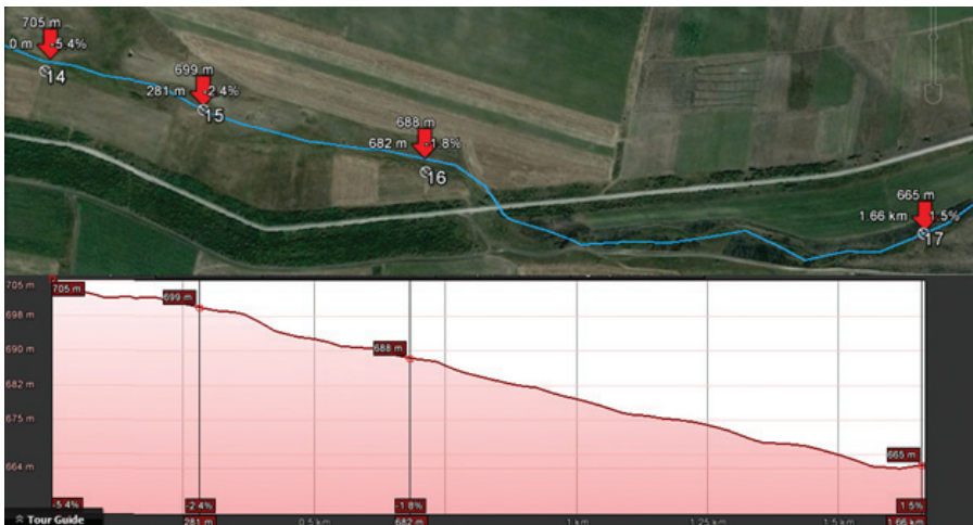
სურათი 4. მოდელირებული ნაკადის სიმაღლითი პროფილი. ისრებით მითითებულია ქაბურღილების განლაგება
