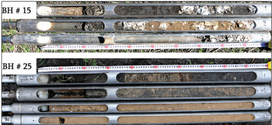
სურათი 5. კერნები გეომორფოლოგიური ბურღილებიდან. #15 აღებულია დიდანურის პალეონაკადის ხეობაში, ხოლო #25 შესაძლო ნატბურიდან შირაქის ველის ცენტრში
