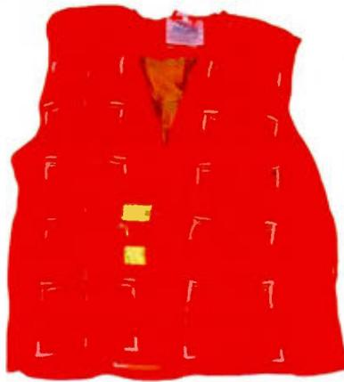
**Figure 4.2** Veste prototype, permettant de contenir les sachets de MCP dans leur forme assemblée
