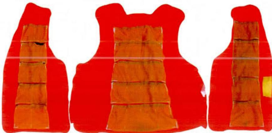
**Figure 4.3** Intérieur de la veste prototype où l'on peut apercevoir les pochettes cousues, permettant de contenir les sachets de MCP
