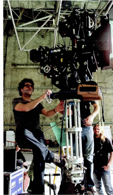
Figure 3 : Une caméra stéréoscopique professionnelle non-motorisée. Cet arrangement pèse au-delà de 90 kilos.
