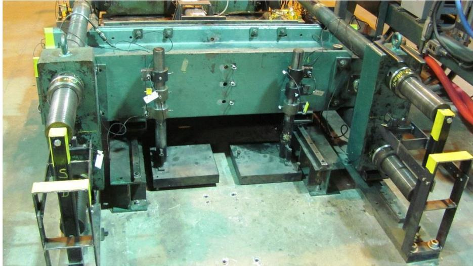
Figure 5-6: LVDT positionnés derrière la mâchoire mobile
