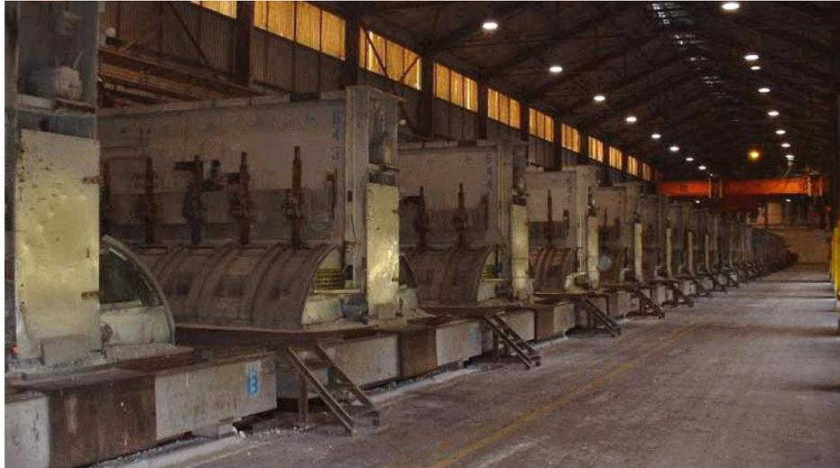
Figure 1-3: Salle de cuve utilisant la technologie P-155 [6]
