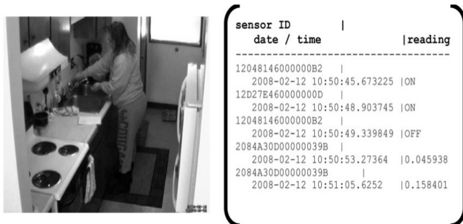
Figure 2.7 : Une résidente qui exerce une activité de "lavage des mains" (gauche). Cette activité déclenche les capteurs de mouvement ainsi que les capteurs de débit d'eau (à droite) [57]
