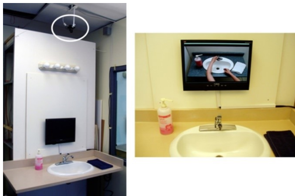
Figure 2.1 : Exemple de configuration du système. (a) Exemple de l'écran, des haut-parleurs et de la caméra vidéo (encerclée). (b) Exemple de message basé sur la vidéo montrant comment tourner le robinet (en haut à droite) [41]
