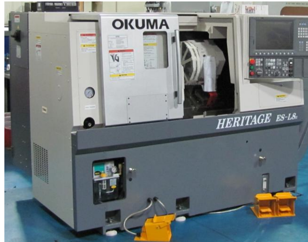
Figura 3.4 Torno CNC OKUMA modelo HERITAGE ES-L8 utilizado para maquinar las copas acetabulares.
