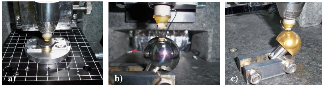
Figura 3.36 Análisis de microscopía de fuerza atómica a: a) muestra testigo, b) cabeza femoral y c) cabeza femoral recubierta por la técnica PVD.
