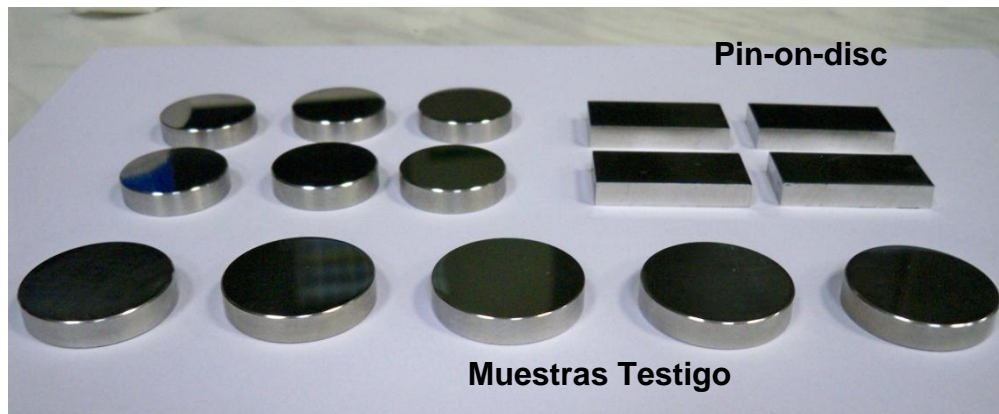
Figura 3.8 Muestras de aleación CoCrMo ASTM F1537-08 fabricadas para las diferentes etapas de la experimentación.
