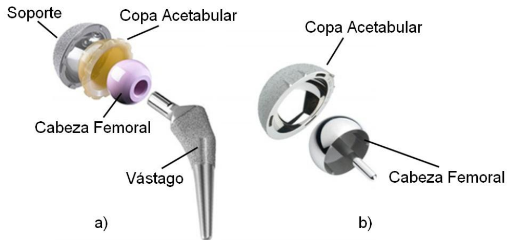
Figura 2.3 Componentes principales de las prótesis de cadera, a) prótesis total de cadera y b) prótesis de resuperficialización (resurfacing) [21].
