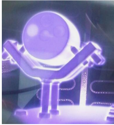
Figura 3.24 Proceso de nitruración iónica.
