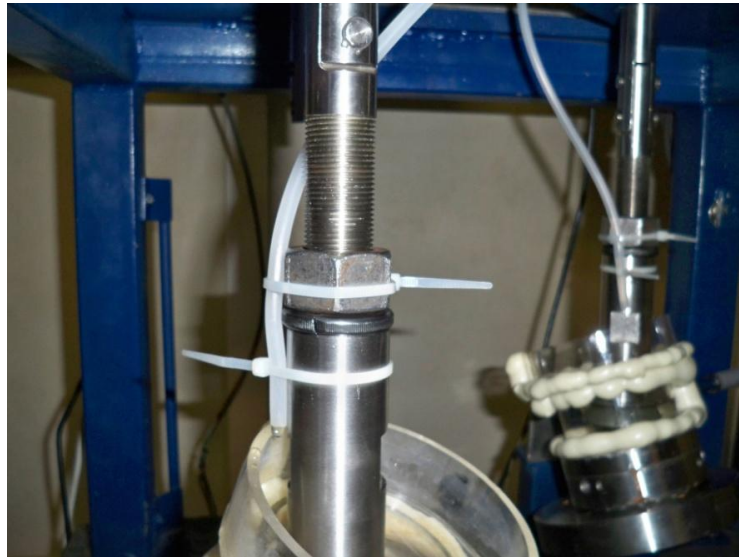
Figura 3.68 Sistema de tuerca-contratuerca listos después de la calibración de la carga y, manguera del sistema automático de suministro de agua sujeta por medio de cinchos.
