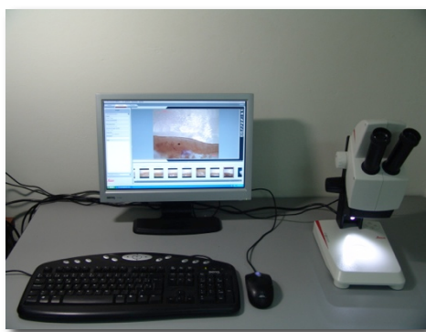
Fig. 5. Equipo de microscopía conectado al ordenador para la captura de imágenes.
