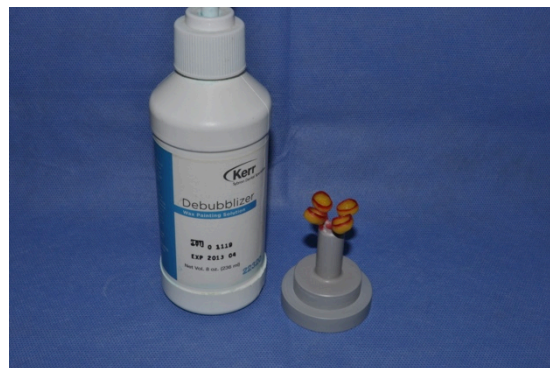
Fig. 31. Sustancia surfactante para eliminar la tensión superficial de la cera.
