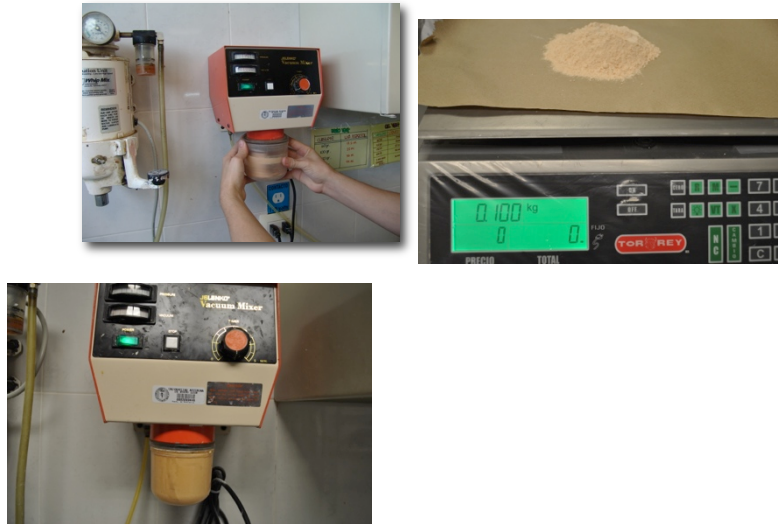
Fig. 19. Dosificación del yeso y mezclado al vacío.
