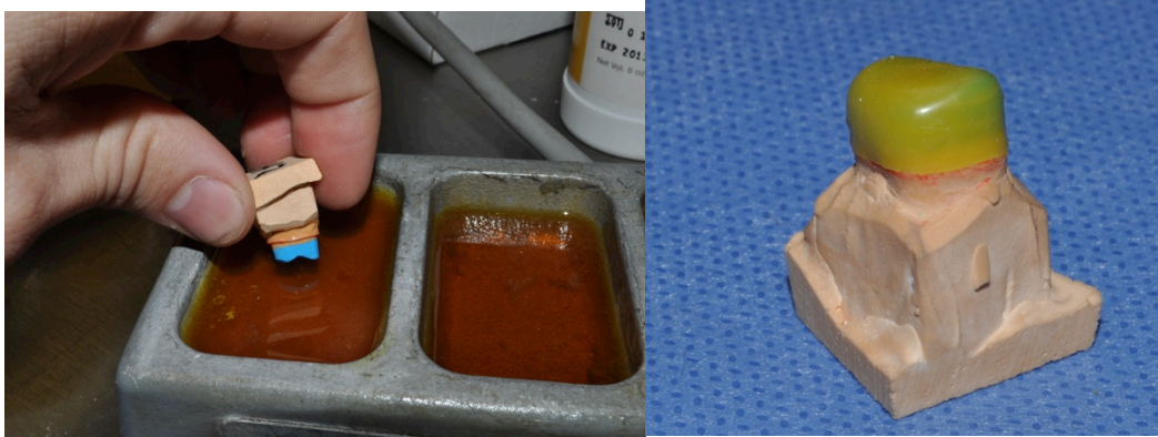
Fig. 26. Inmersión en la cera de los dados dando un espesor de 0.5mm.
