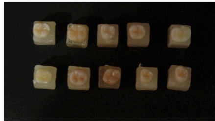
Fig. 4. Los dientes de la muestra fueron colocados en bases de acrílico de autocurado.
