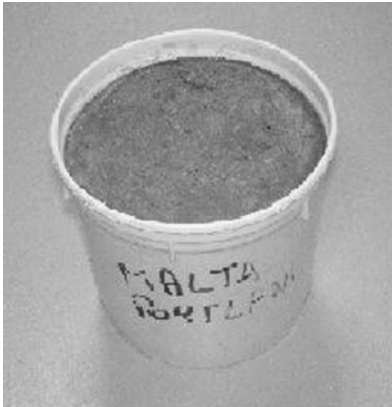
Fig. 11. Sample cured at constant humidity after five years of its preparation (Portland Job site, USA – photos Mapei's archive). Campione di miscela mantenuta in un recipiente sigillato cinque anni dopo la preparazione (cantiere di Portland, USA, fotografie archivio Mapei).
