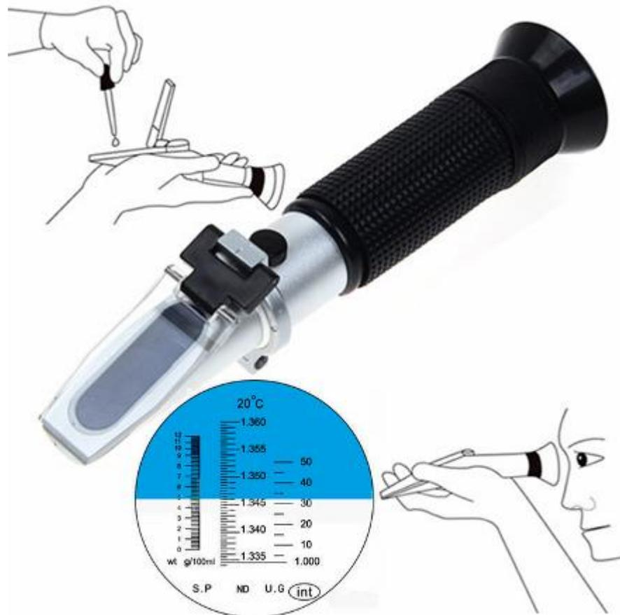
**Figura 18:** Esquema del uso del refractómetro usado para la cuantificación de fibrinógeno a partir del plasma bovino. Se muestra la forma de depositar la muestra y como se realizaría la lectura con la observación de la escala que posee el aparato.
