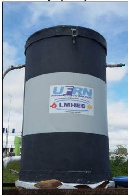
A Figura 52 mostra o sistema de aquecimento solar alternativo (SASA) proposto constituído pelo CSA e RTA, pronto para o ensaio.
