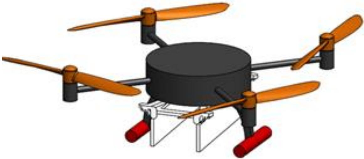
Figura 28 - Modelação 3D de um VANT com semeador acoplado
