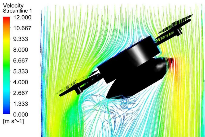
Figura 60 - Linhas de corrente do escoamento no VANT com 30° de inclinação no deslocamento
