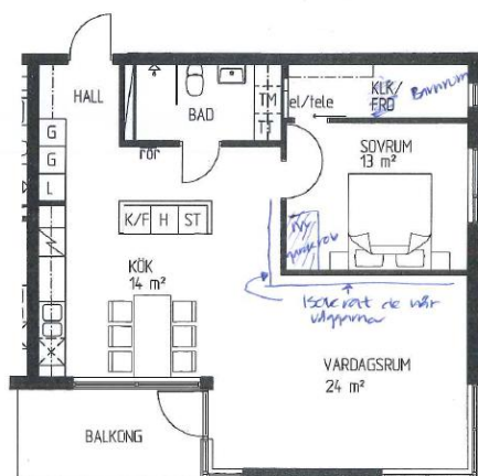
Figur 3: De boende har valt att tilläggsisolera sitt sovrum. Studien visar också att en del boende sänker taket i vissa utrymnen för att få en bättre ljudmiljö.
