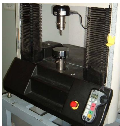
Figura 5.9: macchina universale per prove meccaniche MTS Insight 5
