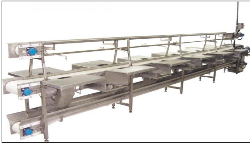
Gráfico 19. Equipo para el eviscerado y descamado
