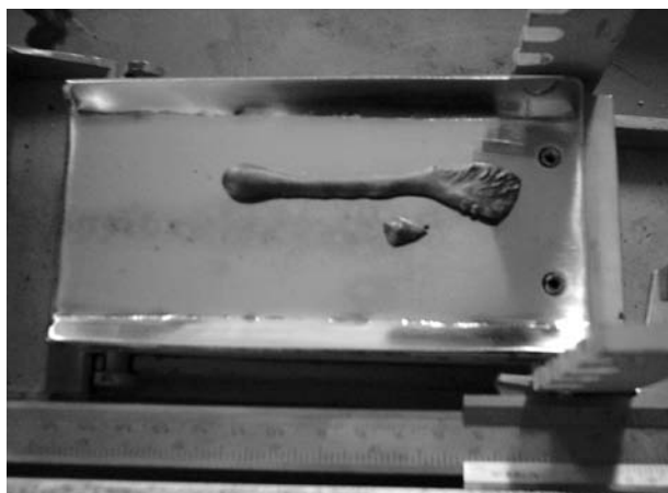
Figura 3. Escoria sometida a un ensayo de plano inclinado.
