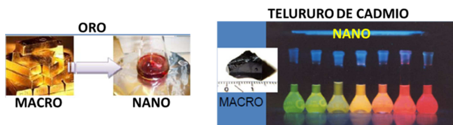
Figura 2: Cambio de propiedades ópticas en la nanoescala: los casos del oro y del telururo de cadmio.
