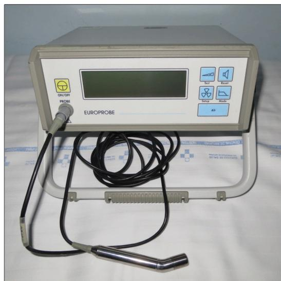
Figura 6. Sonda gamma portátil para identificar los ganglios centinela intraoperatoriamente.
