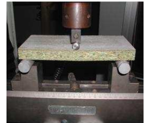
Figura 4.18. Ensayo de flexión del tablero PAR
