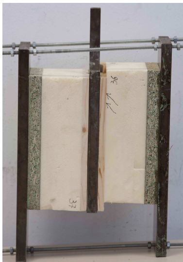
Figura 4.28. Fallo de la probeta C36 por deslizamiento de la unión FRI-XPS
