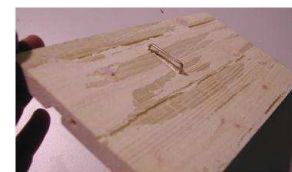
Figura 4.20. Detalle de las tablillas y de su grapado
