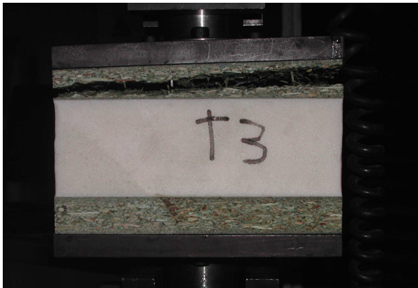
Figura 4.3. Rotura del tablero PAR
