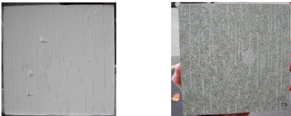
Figura 4.7. Aspecto de la superficie del XPS y del PAR en una probeta. Puede verse la correspondencia entre los restos del XPS dejados en el PAR (a la derecha) y el arrancamiento de esos restos en la plancha XPS (a la izquierda)
