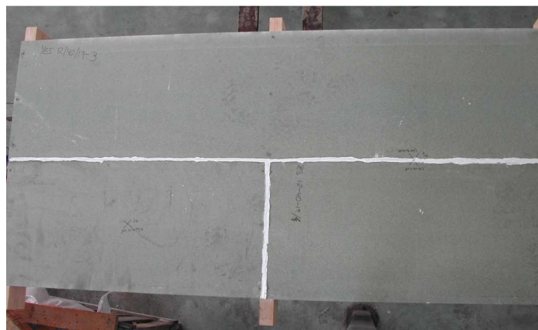
Figura 3.54. Vista del montaje de varios paneles ensamblados, previo al ensayo de impacto por cuerpo blando. Pueden apreciarse las juntas entre panel rellenas con masilla sellante.
