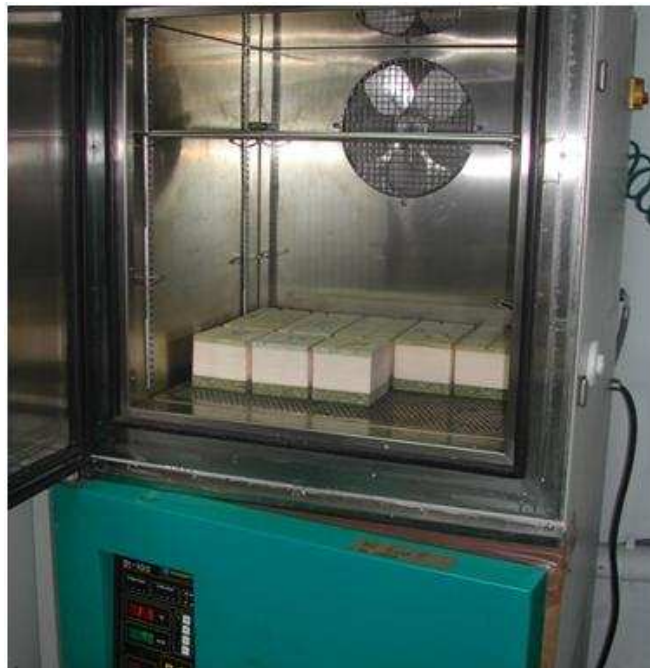
Figura 3.14. Disposición de las probetas en el interior de la cámara climática
