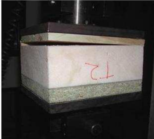
Figura 4.1. Rotura de la unión FRI-XPS
