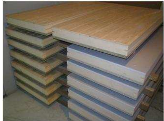
Figura 3.17. Disposición de las probetas en el interior de la cámara climática.
