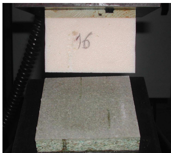
Probeta T16 (acelerado-45 días); momento en que se produce la rotura. 80 kPa
