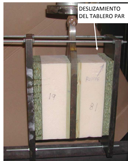
Figura 4.27. Fallo de la probeta C18 por deslizamiento de la unión PAR-XPS
