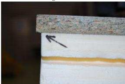
Figura 4.39. Fallo de la probeta PANEL DE YESO-F10. Desliza el tablero PAR respecto al XPS. Detalle del extremo longitudinal del panel
