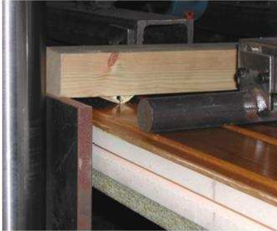
Figura 3.52. Instante del arrancamiento del tornillo respecto a la correa central
