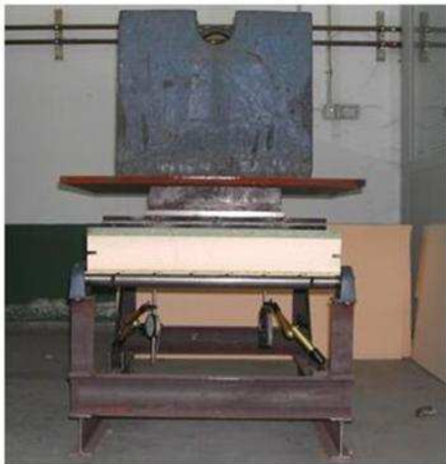
Figura 3.62. Fluencia en flexión, vista de perfil
