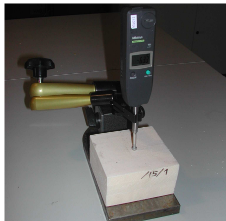
Figura 4.23. Medición de la recuperación de la deformación tras el ensayo de compresión
