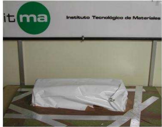
Figura 3.34. Disposición de la bolsa y válvula para extracción a vacío
