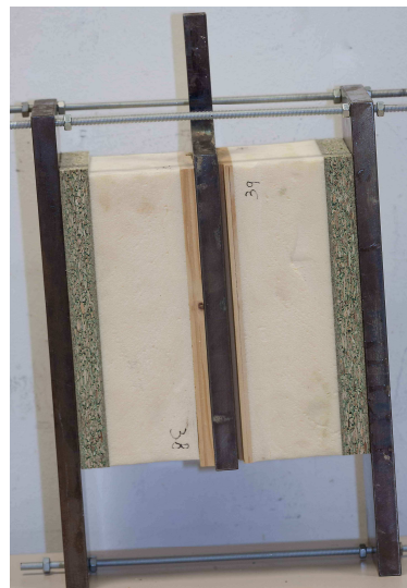
Figura 4.29. Fallo de la probeta C38, se observa deslizamiento en ambas uniones adhesivas
