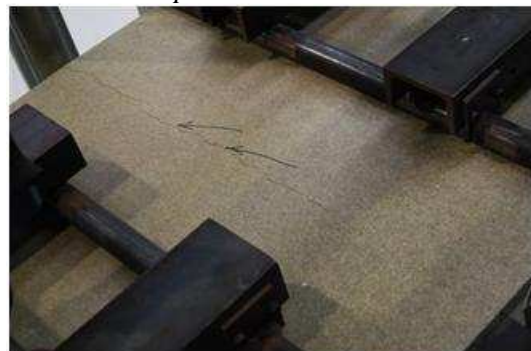
Figura 4.40. Probeta PANEL YESO-F10; detalle de la rotura del tablero PAR en el centro del mismo producida con posterioridad al deslizamiento de las capas constituyentes
