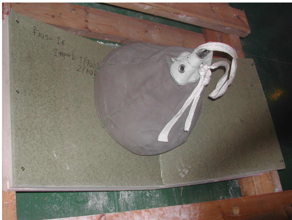
Probeta FRISO-I6 tras el segundo impacto en el que se produce su rotura como se puede ver
