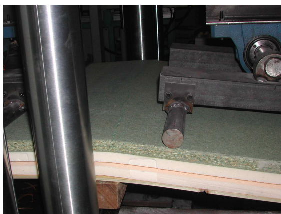
Figura 4.44. Detalle del fallo del tablero PAR en el centro del vano.
