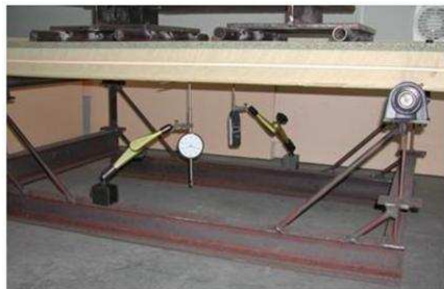
Figura 3.63. Fluencia en flexión, detalle de la captación del incremento de la flecha
