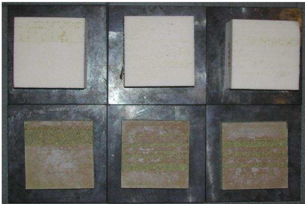
Figura 4.12. De izquierda a derecha: PANEL DE YESO, Lote 5, Probetas R56 7 , R56 8 , R56 9 . En el XPS se aprecian restos de color marrón del adhesivo que se corresponden con las partes más claras en el tablero PAR
