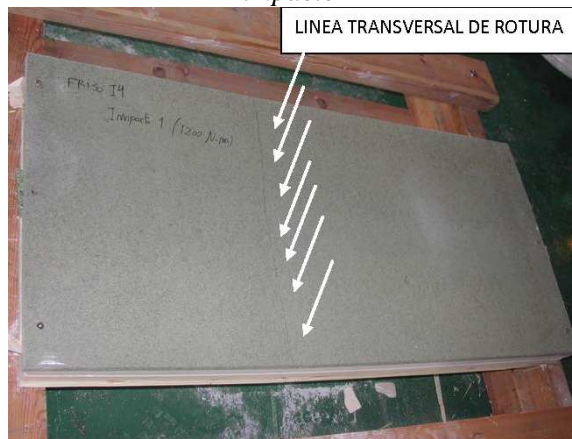
Probeta FRISO-I4, tras el primer impacto ha roto
