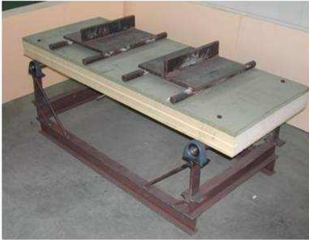
Figura 3.60. Fluencia en flexión, inicio de la disposición de la carga.
