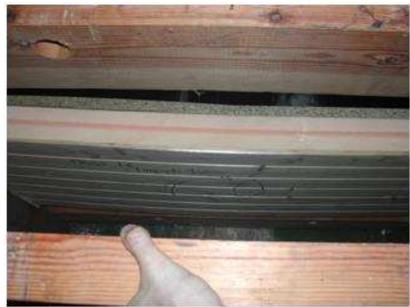
Probeta FRISO-I6 tras el primer impacto: vista de perfil de la deformación que presentó
