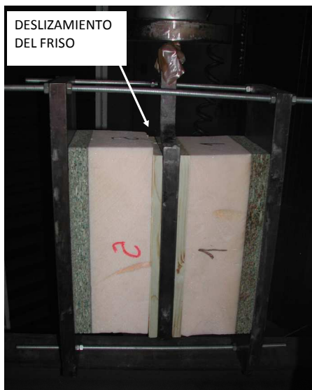
Figura 4.26. Fallo de la probeta C2 por deslizamiento de la unión FRI-XPS
