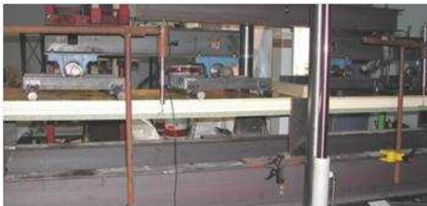
Figura 3.50. Flexión negativa. Puede apreciarse la colocación invertida del panel
