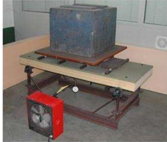
Figura 3.61. Fluencia en flexión, montaje completo
