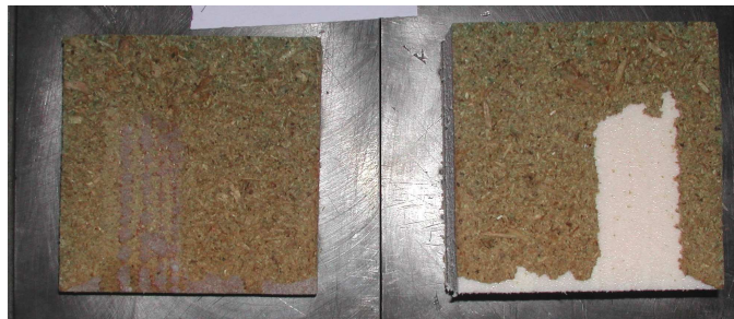
Figura 4.11. Probeta PANEL DE YESO/Lote5/R56 4 . La rotura se ha producido inicialmente en el tablero PAR y posteriormente ha progresado a través de la intercara
