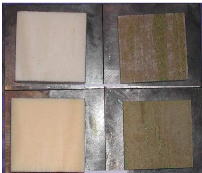
Figura 4.9. La probeta superior es la PANEL DE YESO/Lote5/R28 1 . La probeta inferior es PANEL DE FRISO/Lote3/R28 1 . Las probetas han sido envejecidas 28 días, el adhesivo adquiere un tono marrón. La probeta de la imagen superior es la que ha mostrado, de las dos, una menor resistencia a tracción perpendicular.
