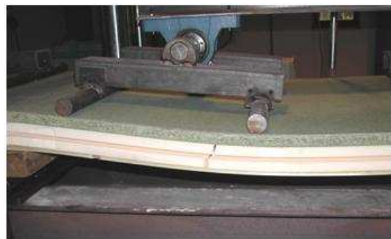
Figura 4.38. Detalle de la rotura producida en la plancha de XPS
