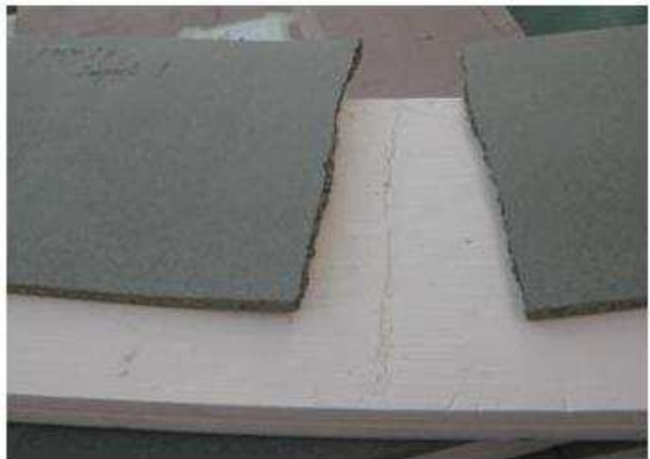
Probeta FRISO-I7 que ilustra el despegue completo del tablero PAR respecto al XPS
