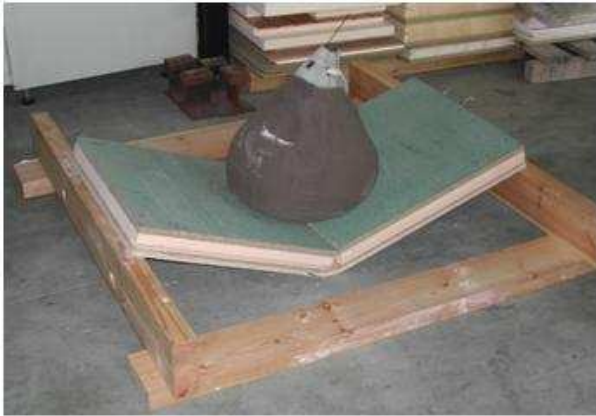
Ejemplo de un panel roto tras el ensayo del impacto
