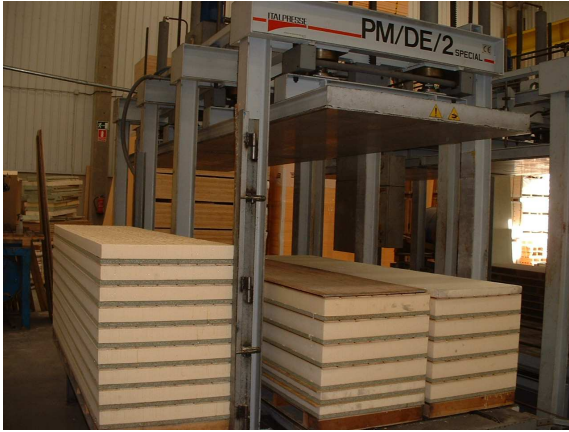
Figura 3.8. Paneles montados a punto de ser prensados
