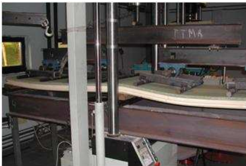
Figura 4.37. Ensayo de flexión positiva; vista general
