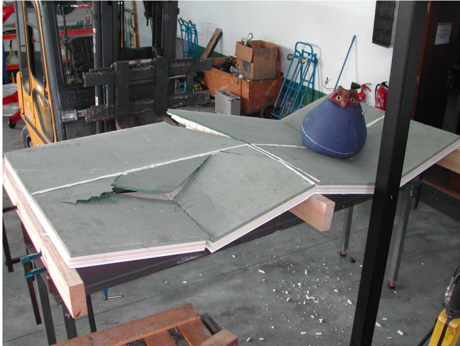
Figura 3.57. Vista general tras varios ensayos de impacto.
