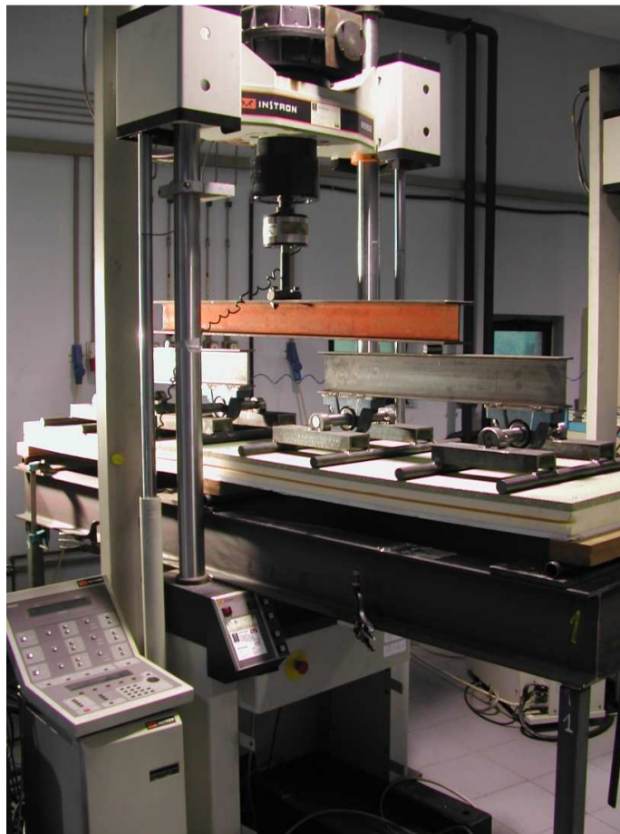
Figura 3.37. Ensayo de flexión positiva; disposición inicial previa al comienzo del ensayo. Instalaciones de Fundación ITMA.
