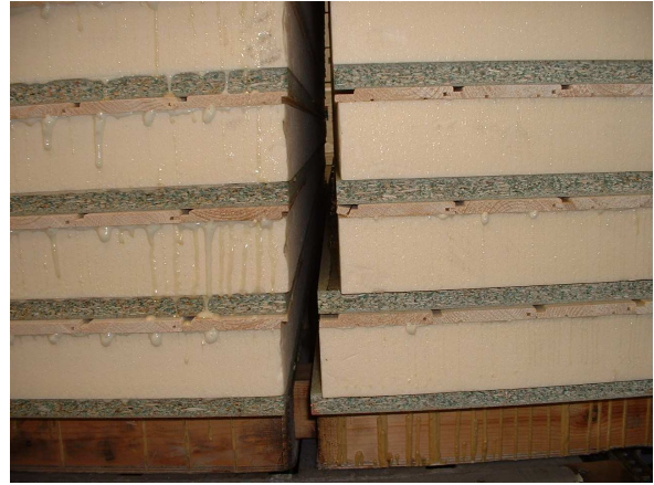
Figura 3.9. Detalle de PANELES DE FRISO durante el proceso del prensado
