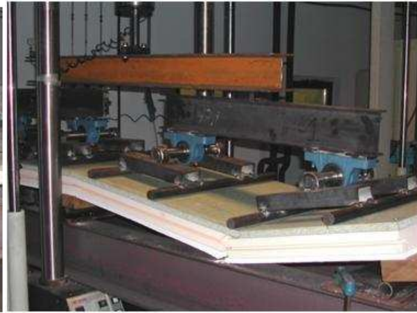
Figura 3.40. Flexión positiva; detalle de la rotura tras un ensayo
