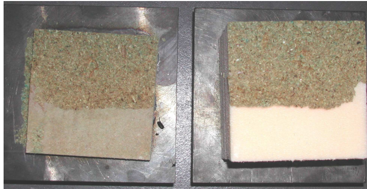
Figura 4.10. Probeta PANEL DE FRISO/Lote3/R28 6 . La rotura se ha producido inicialmente en el tablero PAR y posteriormente ha progresado a través de la intercara
