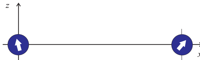
Figura 4.7: Modelo unidimensional de material amorfo magnéticamente blando con dos cristales esféricos magnéticamente duros en sus extremos, para la simulación del efecto de la interacción de canje en el ciclo de histéresis del sistema
