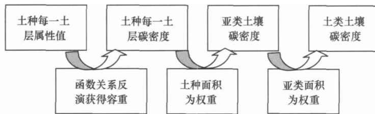
图 2 土壤有机碳密度计算流程图
