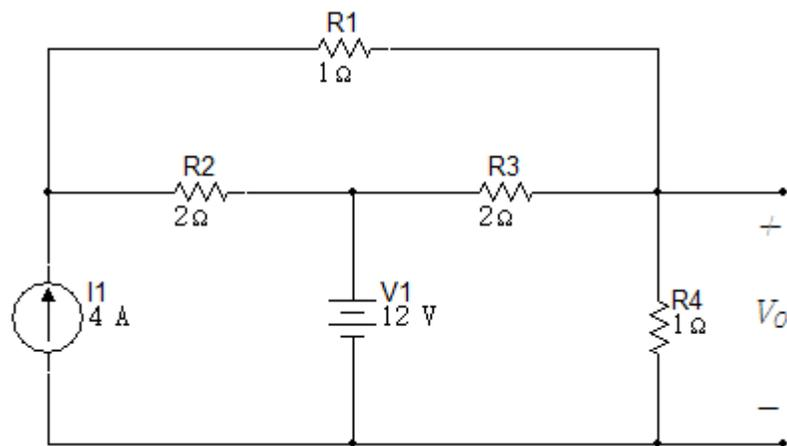
25. Hallar  $i_0$  en el circuito de la figura 6.3.25 usando el teorema de Thévenin.
