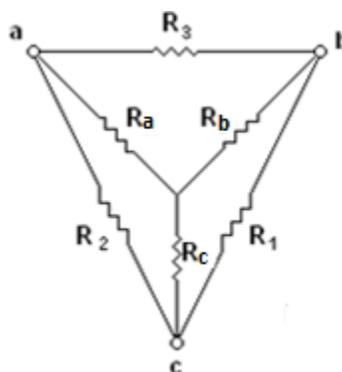
En la figura 2.45 es preciso encontrar valores de  $R_a$ ,  $R_b$  y  $R_c$ , en función de  $R_1$ ,  $R_2$  y  $R_3$ , que hagan que las redes Y -  $\Delta$  sean equivalentes por cualquier medida que se realice en los terminales a, b y c. Sean  $R_{ab}$ ,  $R_{bc}$  y  $R_{ca}$  las
