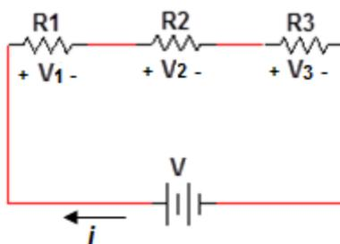
Al aplicar la Ley de Ohm a cada resistor se obtiene:
