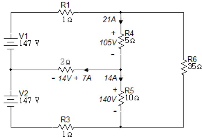
Con los valores dados en la figura se puede obtener por medio de la LKT la tensión en las resistencias  $R_1$  y  $R_3$ :
