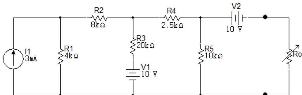
39. La resistencia variable ( $R_0$ ) en el circuito de la figura 6.3.40 está ajustada hasta que la potencia disipada en la resistencia sea de 250W. Encontrar el valor de  $R_0$  que satisface esta condición.
