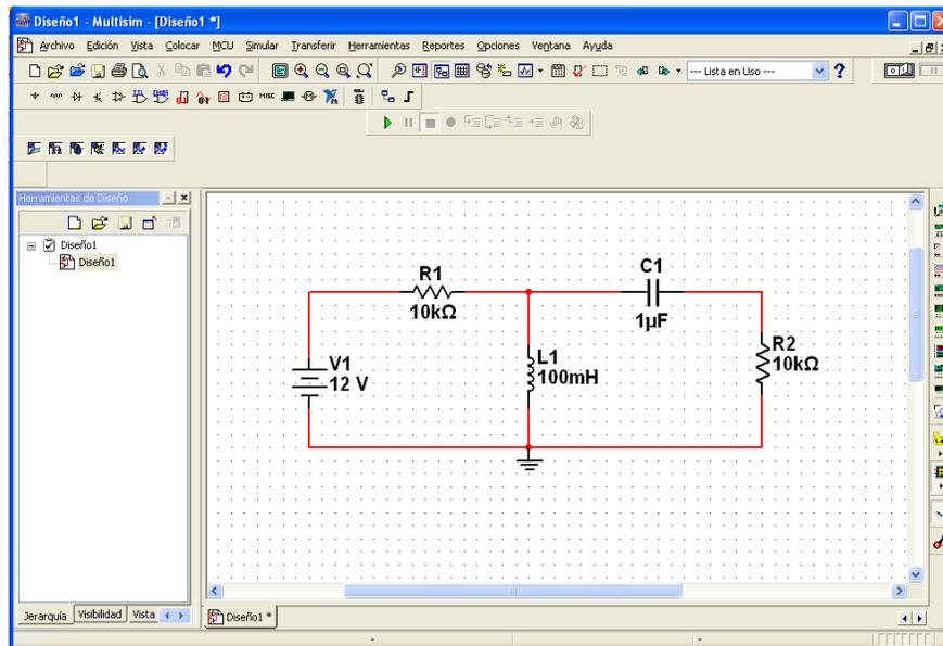
Se necesita tener en cuenta que los valores de tensión y corriente deben ser los reales en cada uno de los elementos del circuito, para ésto se hace uso de un elemento llamado Multímetro.
