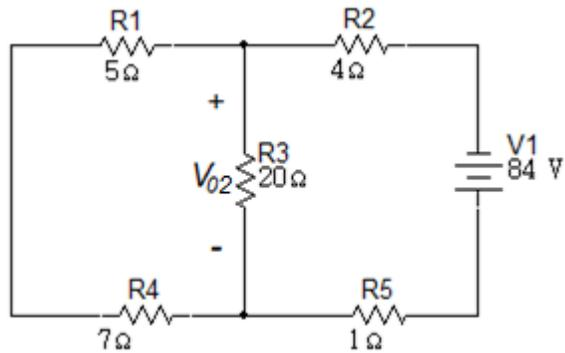
Para obtener la tensión de  $V_{02}$  se realizarán unas reducciones previas.
