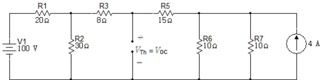
El primer paso es realizar el paralelo de las resistencias  $R_6$  y  $R_7$ .
