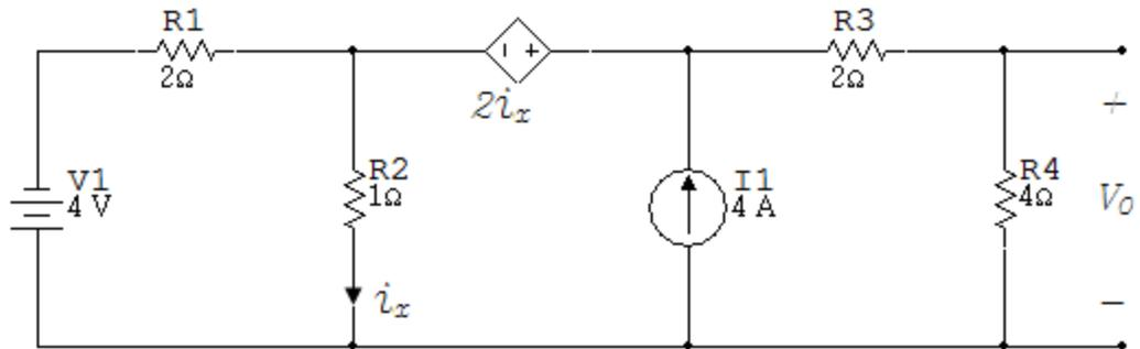
20. Hallar  $V_0$  usando el método de tensiones de nodo en el circuito de la figura 6.2.20.
