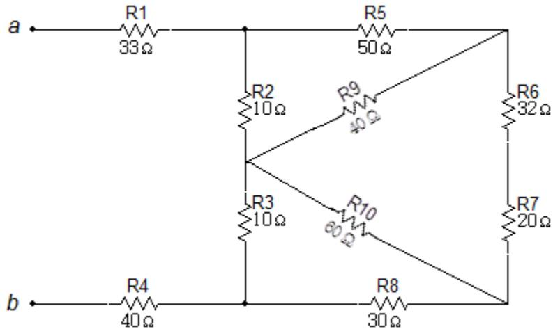
81. Calcule la resistencia vista por la fuente ideal de tensión en el circuito de la figura 6.1.64.
