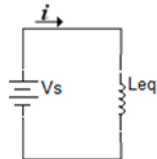
Una conexión en paralelo de  $N$  inductores tiene un circuito equivalente. En cada inductor existe la misma tensión. Al aplicar LKC se tiene:
