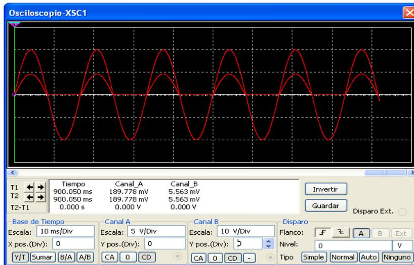
Gracias al osciloscopio se puede apreciar por cada uno de los canales una señal diferente, para este caso por el canal A se midió la señal generada o señal de entrada y con el canal B se toma la señal a la salida. Se puede apreciar que este circuito es un rectificador de media onda.
