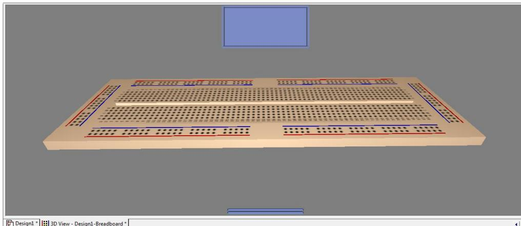
Al abrir la ventana del Protoboard, el cursor se convierte en una flecha bidireccional indicando que se puede rotar el Protoboard en cualquier dirección.
