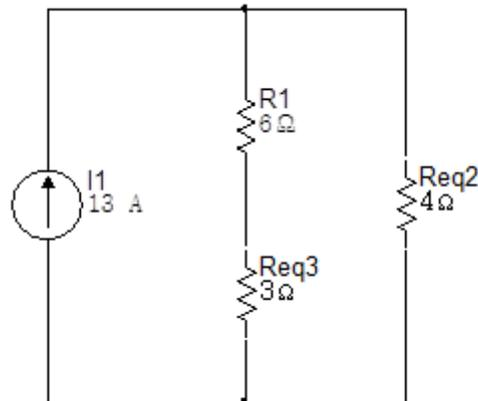
Ahora se halla la resistencia equivalente de las resistencias en serie  $R_1$  y  $R_{eq3}$ .
