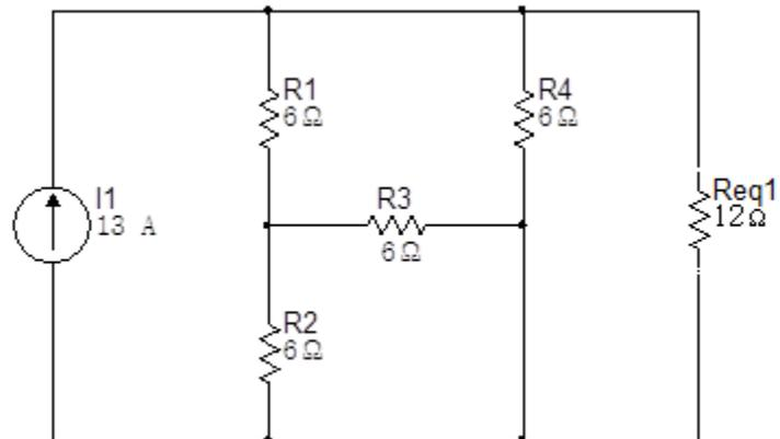
La siguiente reducción será hallando la resistencia equivalente de las resistencias  $6\Omega$  y  $12\Omega$ .
