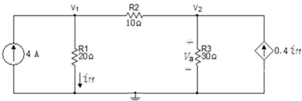
Cuando en un circuito existen fuentes dependientes y se aplica el Principio de Superposición, estas fuentes no se retiran. Se suspenden sólo las fuentes independientes.
