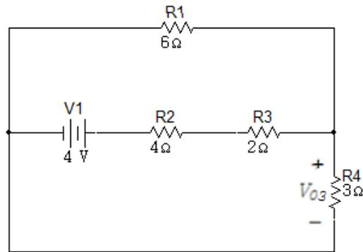
Se realizan dos reducciones para obtener el valor de  $V_{03}$ .
