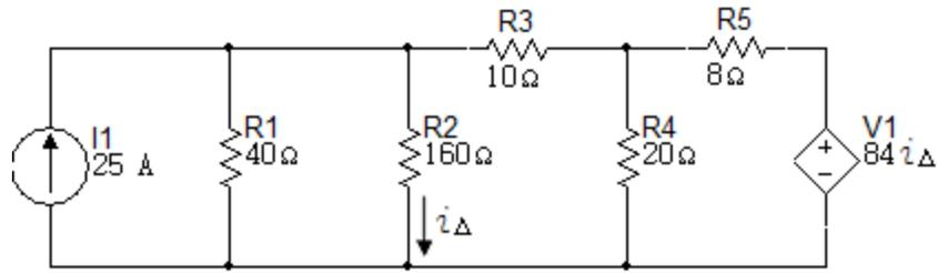
26. Use el método de tensiones de nodos para encontrar  $V_0$  en el circuito de la figura 6.2.26.
