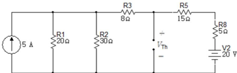
Lo siguiente es realizar el paralelo de las resistencias  $R_1$  y  $R_2$  y la serie de las resistencias  $R_5$  y  $R_8$ .
