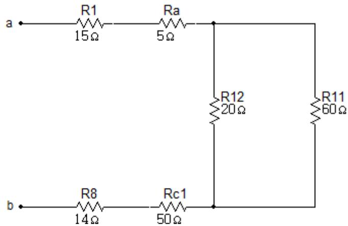
El siguiente paso será el paralelo de las resistencias  $R_{12}$  y  $R_{11}$ :
