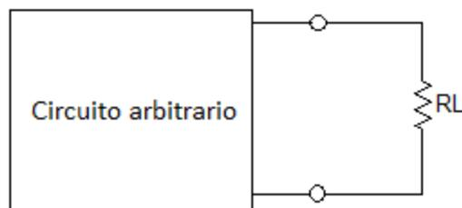
De esto se deduce que uno de los usos principales de los Teoremas de Thévenin y Norton es la sustitución de una gran parte de una red, por un circuito equivalente muy simple. El nuevo y más simple circuito permite llevar a cabo cálculos rápidos de la tensión, la corriente o la potencia que el circuito original es capaz de entregar a la carga; también ayuda a elegir el mejor valor para esta resistencia de carga.
