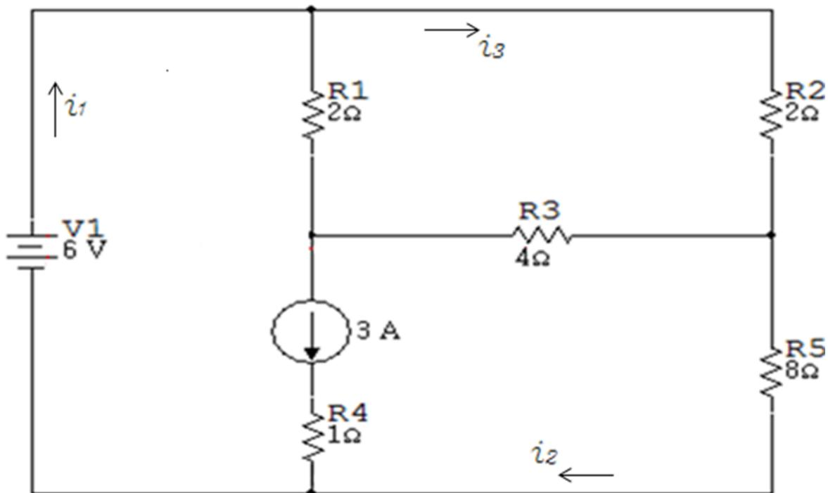
Cuando una fuente de corriente (dependiente o independiente) existe entre dos mallas se crea una supermalla la cual incluye la fuente de corriente y todos los elementos conectados en serie con ella.
