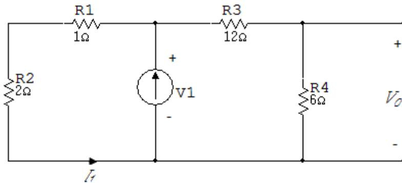
46. Si  $V_0 = 12V$ , encuentre  $V_1$  en el circuito de la figura 6.1.29.
