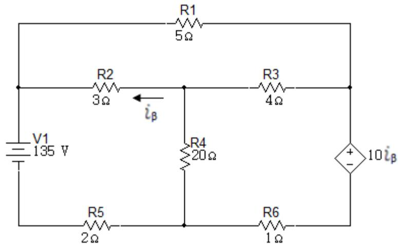
11. Use corrientes de malla para hallar la potencia entregada por la fuente dependiente de tensión en el circuito de la figura 6.2.11.
