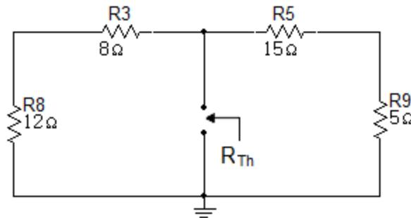
Se realiza la serie de las resistencias  $R_8$  y  $R_3$  y  $R_5$  y  $R_9$ .
