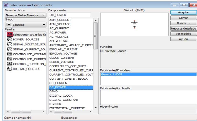
Para asignar el valor correspondiente a la fuente de alimentación seleccionada se hace doble clic sobre el elemento ya puesto sobre el sitio de trabajo, desplegándose la ventana de la figura 1.15 en la que se puede cambiar el valor de la fuente de alimentación.
