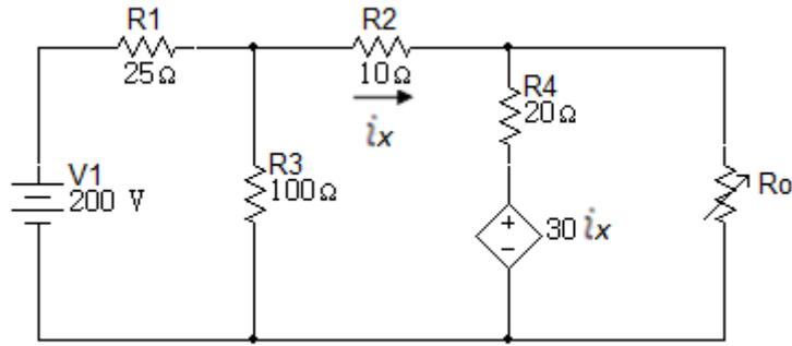
40. La resistencia variable ( $R_0$ ) en el circuito de la figura 6.3.41 está ajustada hasta absorber la máxima potencia transferida al circuito.
