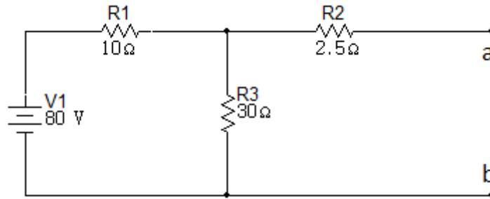
28. Encontrar el equivalente de Thévenin con respecto a los terminales a,b, encontrar la tensión de cortocircuito y la corriente de circuito abierto en el circuito de la figura 6.3.28.
