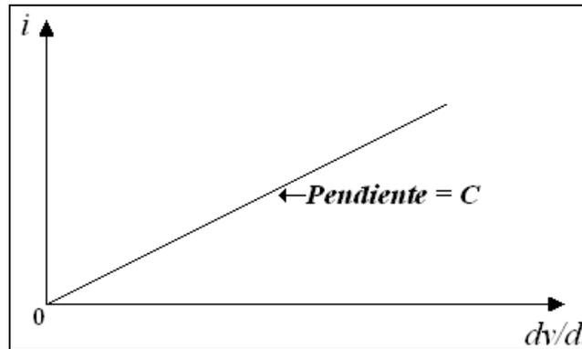
Los capacitores que satisfacen la ecuación (5.5) son lineales, la relación corriente-tensión del capacitor, puede obtenerse integrando en ambos lados de la ecuación (5.5).
