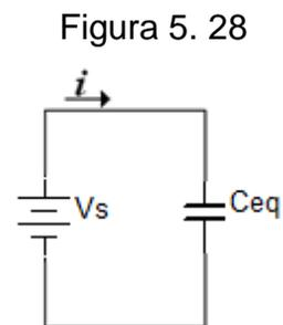
En el circuito de la figura 5.27 la corriente es la misma para todos los capacitores. Al aplicar LKT al lazo de la figura 5.25.
