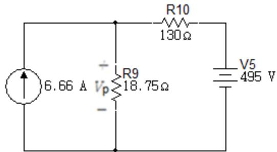
La siguiente transformación es la de la fuente de tensión en una fuente de corriente en paralelo con la resistencia de  $130\Omega$ .
