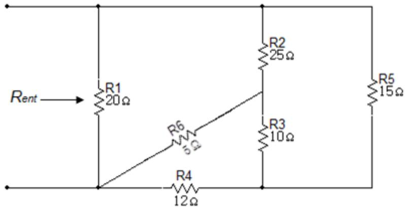
79. Utilice una transformación  $\Delta - Y$  para calcular las tensiones  $V_1$  y  $V_2$  en el circuito de la figura 6.1.62.
