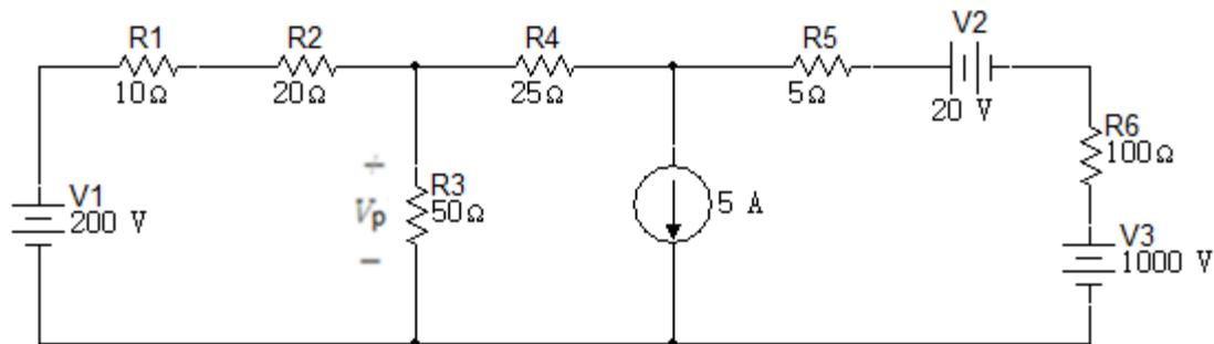
Se realiza la suma de las resistencias en serie  $R_1$  y  $R_2$  y la suma de las resistencias en serie  $R_5$  y  $R_6$ .
