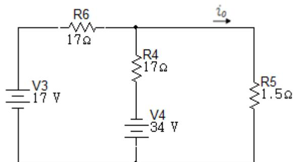
Lo siguiente será realizar las transformaciones de las fuentes de tensión en fuentes de corriente en paralelo con las resistencias correspondientes:
