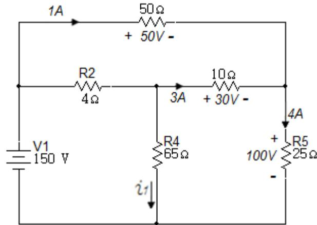
Se aplica la LKT para obtener la tensión en la resistencia de  $65\Omega$ .
