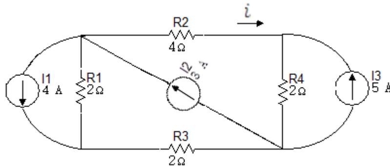
17. Determinar  $V_p$  usando transformaciones de fuentes en el circuito de la figura 6.3.17.
