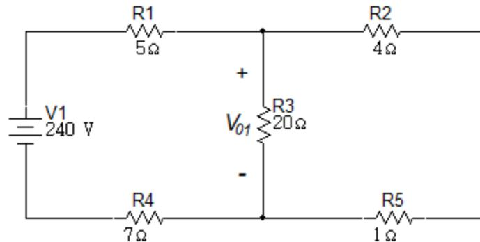
Para obtener la tensión  $V_{01}$ , se realiza una serie de reducciones. La primera reducción será la serie entre las resistencias  $4\Omega$  y  $1\Omega$ .
