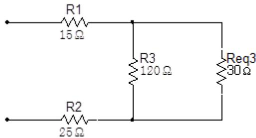
Continuando con la reducción del circuito hallamos el equivalente entre las resistencias  $R_{eq3}$  y  $R_3$ :
