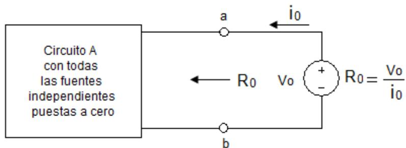
En la aplicación del Teorema de Thévenin, el circuito B (el cual a menudo se denomina carga) puede constar de muchos elementos de circuito, de un elemento único, o puede no tener elementos (esto es, el circuito B puede ser un circuito abierto).
