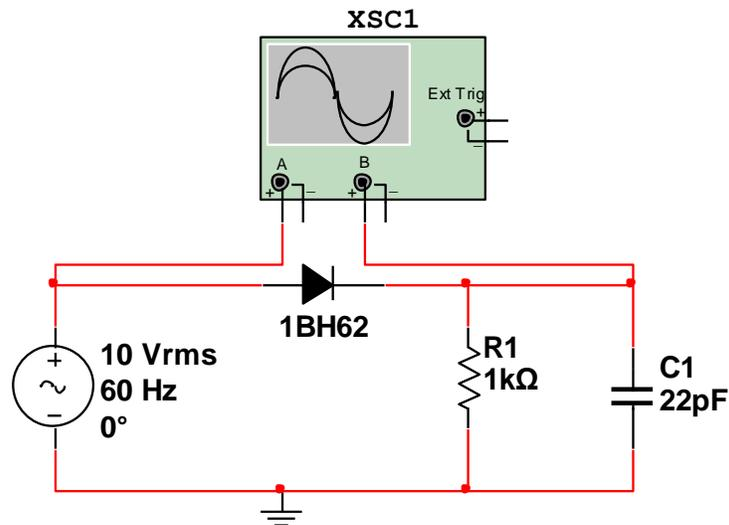
Figura 1. 36 Entrada y salida del circuito rectificador de media onda
