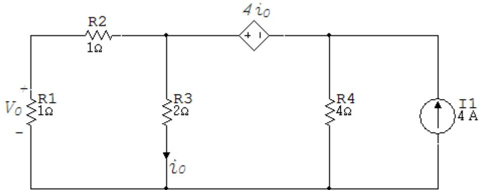
24. Use el método de tensiones de nodos para encontrar la potencia total disipada en el circuito de la figura 6.2.24.
