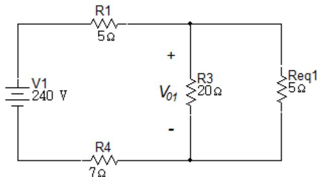
La siguiente reducción será la resistencia equivalente entre el paralelo de las resistencias  $20\Omega$  y  $R_{eq1}$ .
