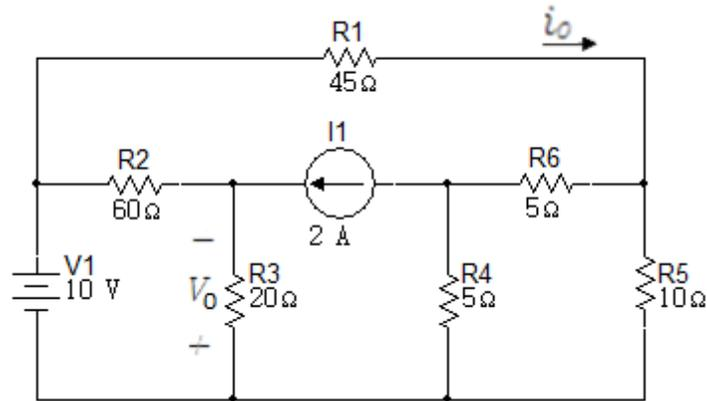
10. Use el principio de superposición para encontrar  $i_o$  en el circuito de la figura 6.3.10.
