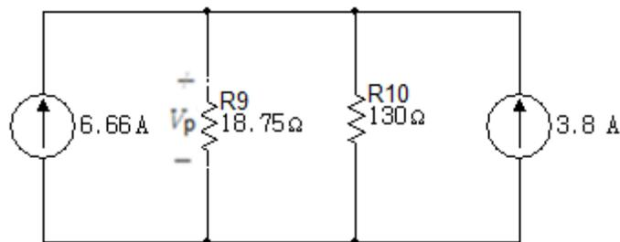
Lo siguiente es realizar la suma algebraica de las fuentes de corriente y el paralelo entre las resistencias  $R_9$  y  $R_{10}$ .
