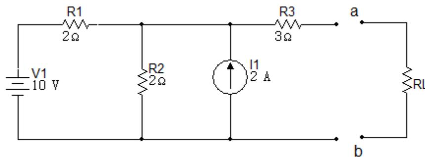
47. La resistencia variable ( $R_0$ ) en el circuito de la figura 6.3.48 se ajusta hasta que se absorba la potencia máxima del circuito.
