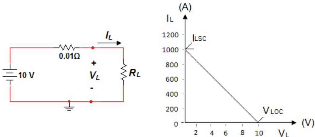
Cada punto sobre la línea es un valor diferente de  $R_L$ , cuando  $R_L = \infty$  y no circula corriente a través de la carga, la fuente práctica está en circuito abierto y la tensión entre terminales es  $V_{LOC} = 10V$ .
