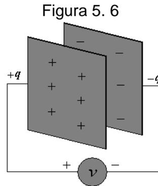
El capacitor es un elemento pasivo que almacena energía por medio de su campo eléctrico. Un capacitor está compuesto por dos placas conductoras separadas por un aislante o dieléctrico como se muestra en la figura 5.5.
