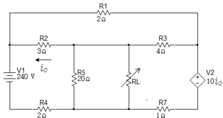
43. El resistor variable en el circuito de la figura 6.3.44 es ajustado para la máxima transferencia de potencia a  $R_L$ .
