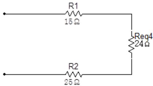
Por ultimo para obtener el valor de la resistencia  $R_{ab}$  se suman las tres resistencias conectadas en serie:
