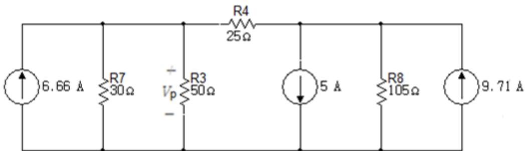
A continuación se realiza la suma algebraica de las fuentes de corriente 5A y 9.71A y el valor de la resistencia  $R_9$ , equivalente del paralelo entre  $R_7$  y  $R_3$ .
