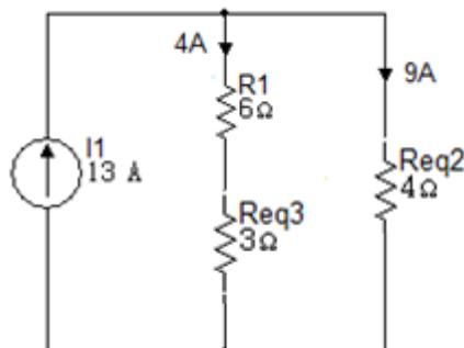
En el circuito anterior la resistencia de  $3\Omega$  es el equivalente del paralelo de las resistencias de  $6\Omega$ , estas resistencias al estar en paralelo tienen la misma tensión. La corriente se divide en dos partes iguales ya que las resistencias tienen el mismo valor.
