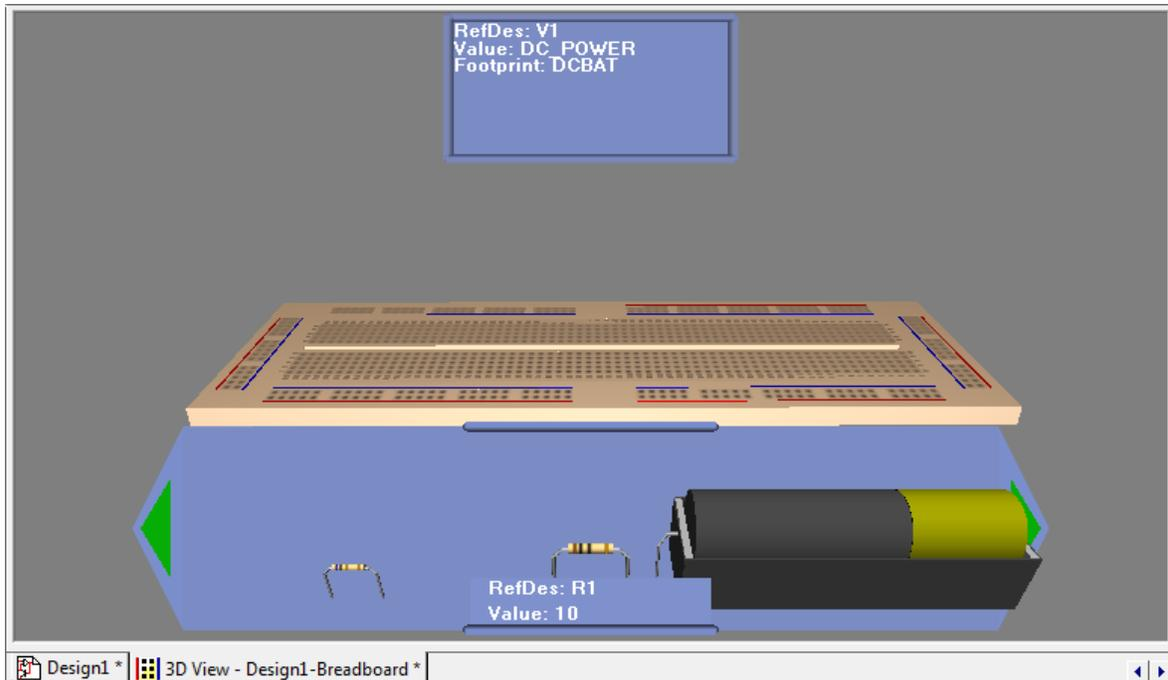
En la figura 1.44 se observa la ventana del Protoboard con los componentes que se utilizaron en la simulación y en la ventana de la parte superior se observa la especificación de la fuente de tensión DC. Así como muestra la especificación de la fuente, se puede hacer con cada uno de los componentes que se encuentren en la ventana inferior.
