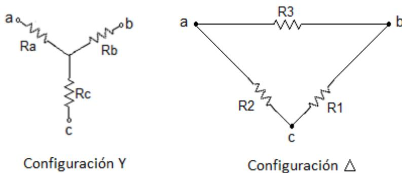
El propósito es desarrollar las ecuaciones para efectuar las conversiones de ( $\Delta$ ) en (Y), o viceversa. Este tipo de conversión conducirá normalmente a una red que se podrá resolver utilizando cualquier técnica de análisis de circuitos.
