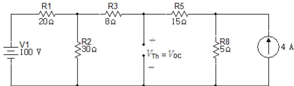
Lo siguiente es la transformación de la fuente de 100V en serie con la resistencia  $R_1$  en una fuente de corriente en paralelo con la resistencia de  $20\Omega$  y la transformación de la fuente de corriente de 4A en paralelo con la resistencia  $R_8$  en una fuente de tensión en serie con la resistencia  $5\Omega$ .
