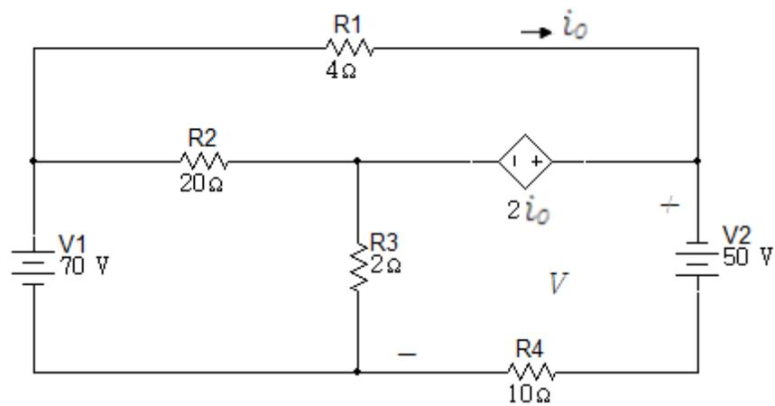
7. Use el principio de superposición para encontrar  $V_0$  en el circuito de la figura 6.3.7.
