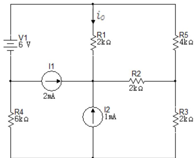
33. Encontrar el equivalente de Norton con respecto a los terminales a, b para el circuito de la figura 6.3.33.
