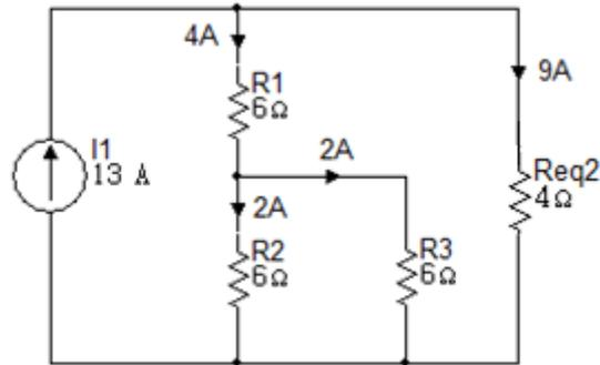
Teniendo la corriente que circula por la resistencia de  $6\Omega$  se puede calcular el valor de  $V_0$ .
