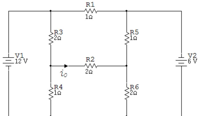
19. Usando el análisis nodal hallar  $V_0$  en el circuito de la figura 6.2.19.
