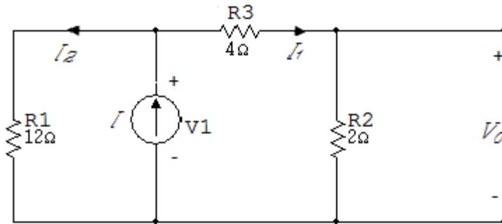
47. La potencia absorbida por el resistor  $4\Omega$  en el circuito es de  $64W$ .
