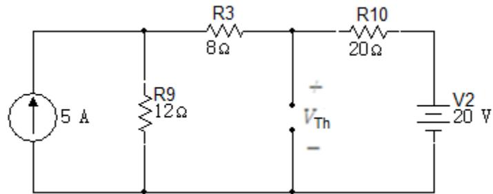
El siguiente paso es la transformación de la fuente de corriente de 5A en una fuente de tensión en serie con la resistencia de 12Ω.
