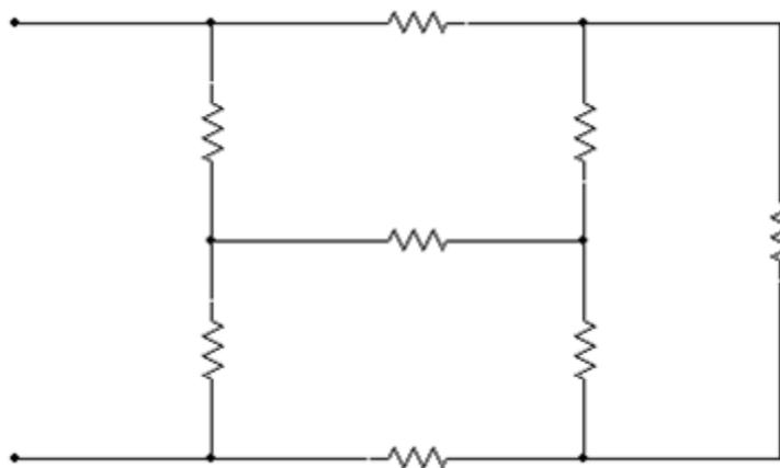
76. Determinar  $R_{ent}$  para la red mostrada en el circuito de la figura 6.1.59.
