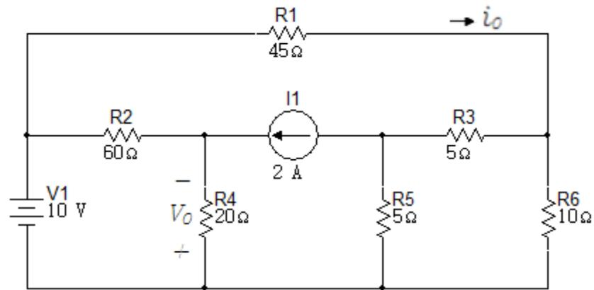
4. Use el principio de superposición para encontrar la tensión  $V_0$  en el circuito de la figura 6.3.4.
