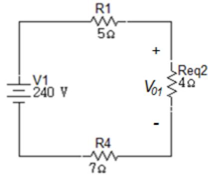
Por división de tensión se obtiene  $V_{01}$ .
