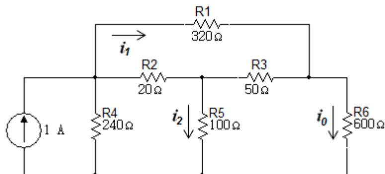
Después de la estrella formada por las resistencias  $20\Omega$ ,  $100\Omega$ ,  $50\Omega$  se sustituye por la delta equivalente del circuito de la figura 2.60.
