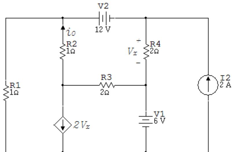
23. Encontrar  $V_0$  usando ecuaciones de nodo en el circuito de la figura 6.2.23.
