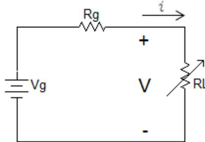
$$P_L = \left( \frac{V_g}{R_g + R_L} \right)^2 * R_L \quad (4.9)$$
