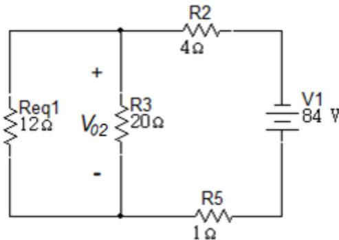
La siguiente reducción será el paralelo entre las resistencias  $12\Omega$  y  $20\Omega$ .
