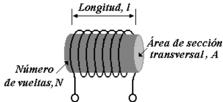
El inductor es un elemento pasivo que almacena energía por medio de su campo magnético. Todo conductor de corriente eléctrica tiene propiedades inductivas y es posible considerarlo como un inductor. Sin embargo, para incrementar el efecto inductivo, un inductor práctico suele formarse por una bobina cilíndrica con muchas vueltas de alambre conductor como se muestra en la figura 5.1.
