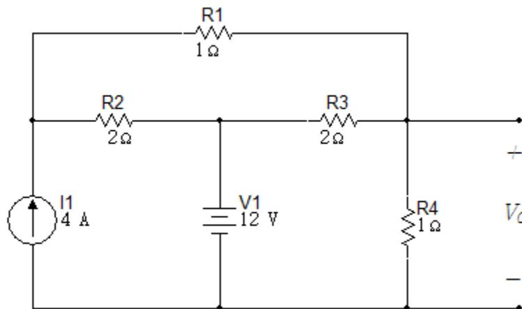
31. Encuentre  $V_0$  en el circuito de la figura 6.3.31 usando el teorema de Thévenin.
