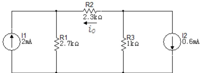
12. Use una serie de transformaciones de fuentes para encontrar  $i_0$  en el circuito de la figura 6.3.12. Verifique la respuesta usando el método de corrientes de malla para encontrar  $i_0$ .
