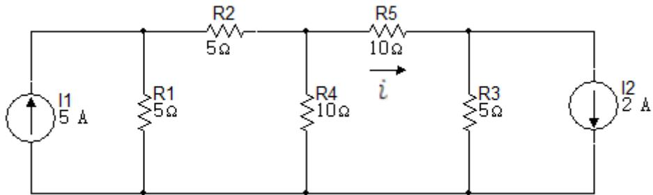
16. Determinar la corriente  $i$  en el circuito de la figura 6.3.16 por transformaciones de fuentes.
