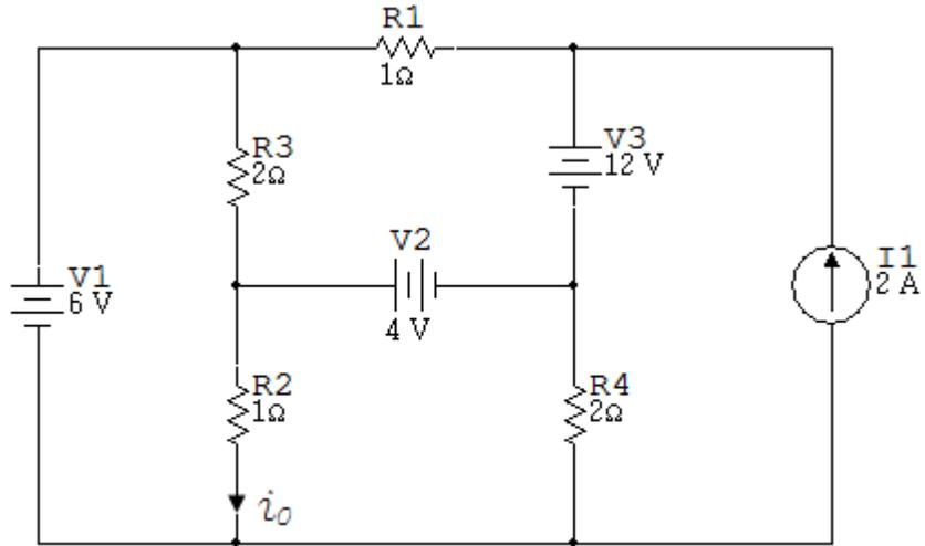
18. Usando el método de tensiones de nodo encontrar  $i_o$  en el circuito de la figura 6.2.18.
