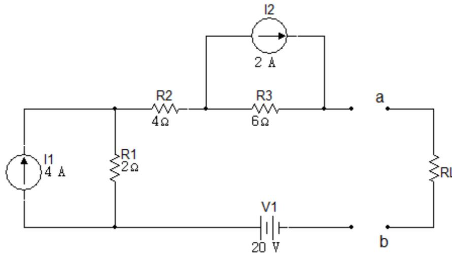
46. Determine el valor de  $R_L$  para la máxima transferencia de carga al circuito de la figura 6.3.47 y la máxima potencia transferida.
