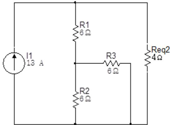
La siguiente reducción será el paralelo de las resistencias  $R_2$  y  $R_3$ .
