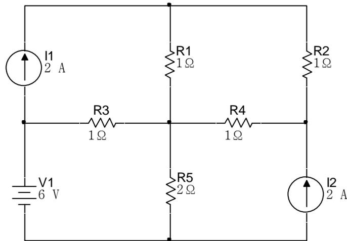
2. Usando ecuaciones de malla hallar  $i_0$  en el circuito de la figura 6.2.2.
