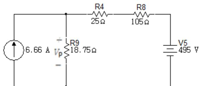
En el siguiente circuito se realizara la suma de las resistencias en serie 25Ω y 105Ω.
