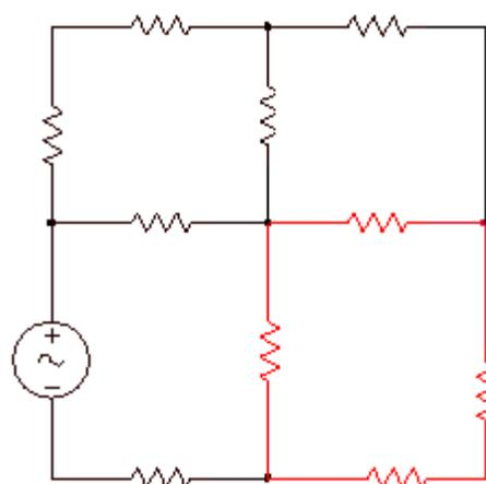
Si una red es plana, se puede usar el Análisis de Mallas. Esta técnica usa el concepto de corriente de malla.
