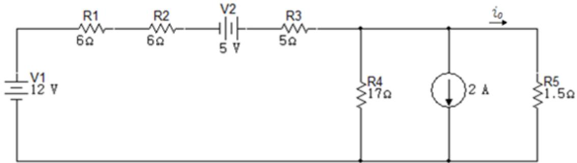
Se hará la suma algebraica de las fuentes de tensión y la serie de las resistencias del circuito. También se realizará la transformación de la fuente de corriente de 2A en una fuente de tensión en serie con la resistencia de 17Ω.
