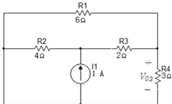
Inicialmente se transforma la fuente de corriente, en fuente de tensión equivalente:
