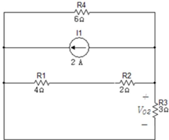
Haciendo reducciones de resistencias en serie y paralelo se obtiene la tensión  $V_{02}$  cuando actúa la fuente de 2 A.
