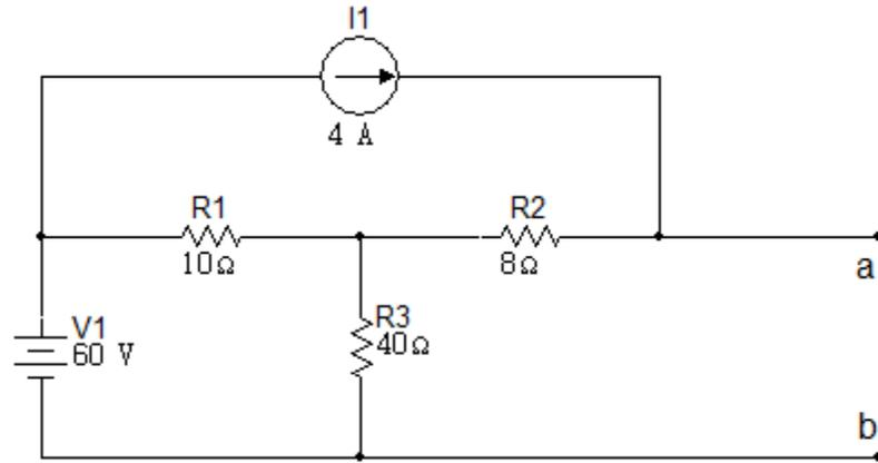
34. Encontrar el equivalente de Norton con respecto a los terminales a, b para el circuito de la figura 6.3.34.
