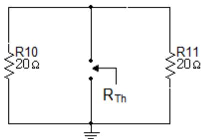
Por último, el paralelo de las resistencias  $R_{10}$  y  $R_{11}$  da como resultado  $R_{Th}$ .
