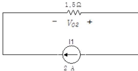
Al estar en paralelo la tensión es la misma para todas las otras resistencias, la tensión  $V_{02}$  es  $-3V$  debido a la polaridad asignada en el circuito.
