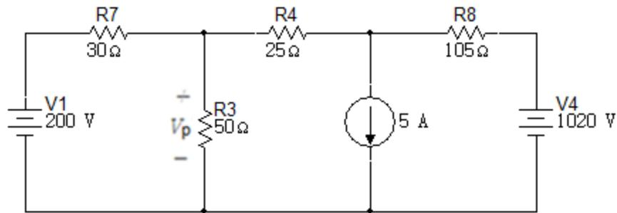
Las próximas transformaciones serán: La fuente de tensión de 200V en una fuente de corriente en paralelo con la resistencia de 30Ω, y la fuente de 1020V en paralelo con la resistencia de 105Ω.
