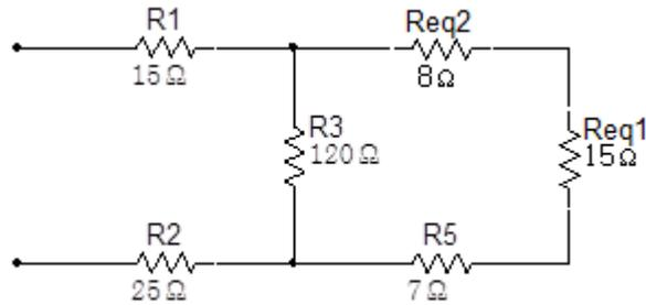
La siguiente reducción será la suma de las resistencias en serie  $R_{eq1}$ ,  $R_{eq2}$  y  $R_5$ :
