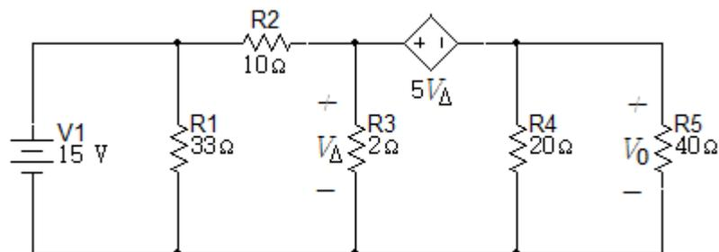
30. Usar tensiones de nodo para verificar el equilibrio de potencia del circuito de la figura 6.2.30.
