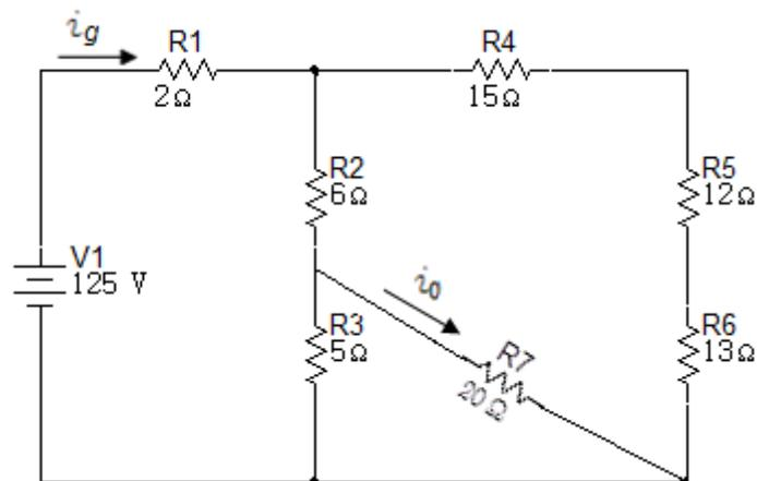
72. Para el circuito de la figura 6.1.55 calcule:
