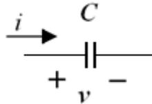
La figura 5.7 presenta el símbolo de circuito para los capacitores. Se observa que de acuerdo con la convención pasiva de signos, se considera que la corriente fluye hacia el terminal positivo del capacitor, cuando éste se está cargando, y que sale de la terminal positiva cuando el capacitor se descarga.
