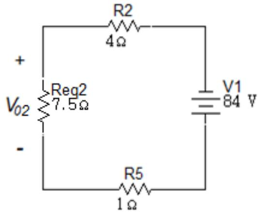
Por división de tensión se obtendrá  $V_{02}$ .
