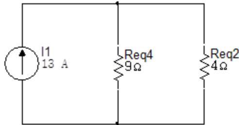
El paso siguiente es calcular las corrientes que circulan por las dos resistencias restantes y devolverse hallando la tensión en cada resistencia de los circuitos anteriores.
