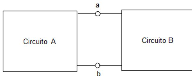
Supóngase que el circuito A no contiene una fuente dependiente que sea dependiente de un parámetro del circuito B, y viceversa. Entonces puede substituirse el circuito A por una fuente de tensión independiente apropiada, llamada  $V_{oc}$ , en serie con una resistencia apropiada llamada  $R_o$ , y el efecto sobre el circuito B es el mismo que el producido por el circuito A.
