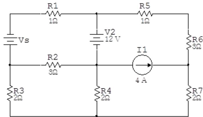
59. Con  $I_0 = 2mA$  encontrar  $V_0$  en el circuito de la figura 6.1.42.
