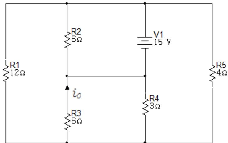
26. Hallar  $i_0$  en el circuito de la figura 6.3.26 usando el teorema de Thévenin.
