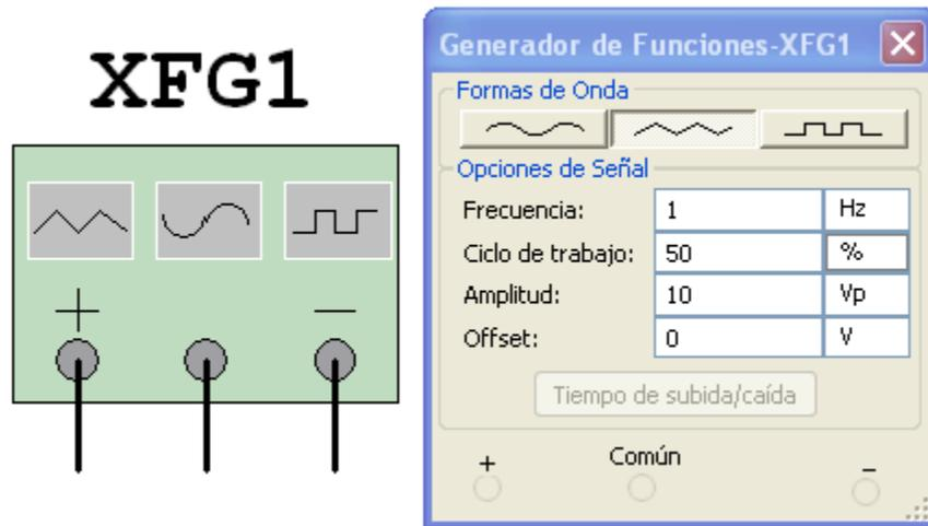
En la parte inferior de la ventana en la que se visualiza la señal de salida se pueden cambiar ciertos parámetros de la onda como la escala en amplitud, frecuencia y ciclo de trabajo.
