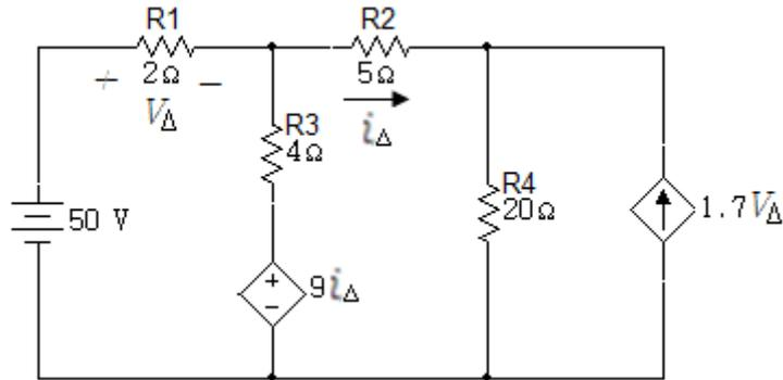
16. Use el método de corrientes de malla para encontrar las corrientes de rama en  $i_a - i_e$  en el circuito de la figura 6.2.16.
