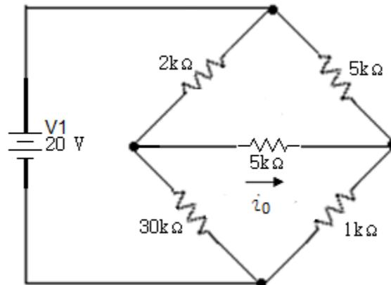
29. Use el método de tensiones de nodos para encontrar  $V_0$  en el circuito de la figura 6.2.29.
