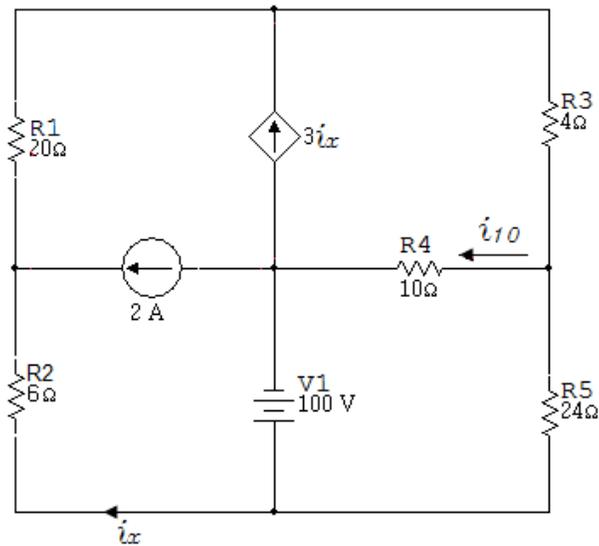
En el circuito de la figura 3.28 se subraya la supermalla formada por la fuente dependiente de corriente.
