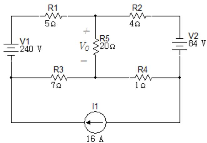
5. Use el principio de superposición para encontrar la corriente  $i_0$  en el circuito de la figura 6.3.5.
