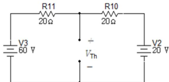
Se realiza la suma algebraica de las tensiones para obtener el valor de  $V_{Th}$
