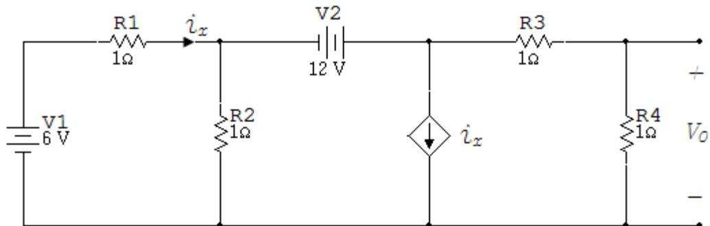
21. Usando el método de tensiones de nodo hallar  $i_0$  en el circuito de la figura 6.2.21.
