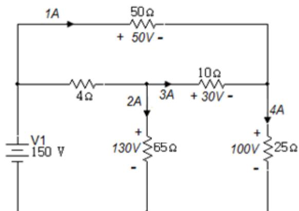
Teniendo la tensión en la resistencia de  $65\Omega$  se aplica la LKT para obtener la tensión en la resistencia de  $4\Omega$ .
