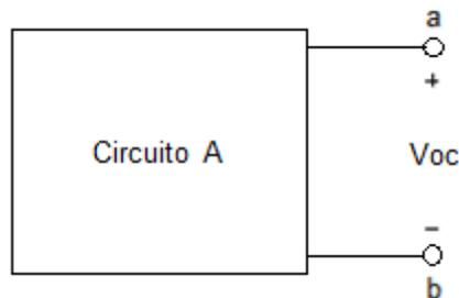
Para obtener la resistencia  $R_o$ , que se denomina resistencia equivalente de Thévenin, separamos de nuevo el circuito B del circuito A. A continuación se harán todas las fuentes independientes en el circuito A iguales a cero.
