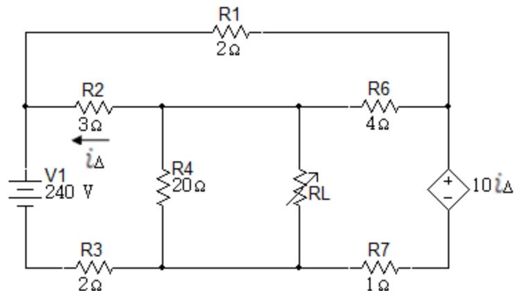
42. La Resistencia variable  $R_L$  en el circuito de la figura 6.3.43 es ajustada para la máxima potencia transferida a  $R_L$ .
