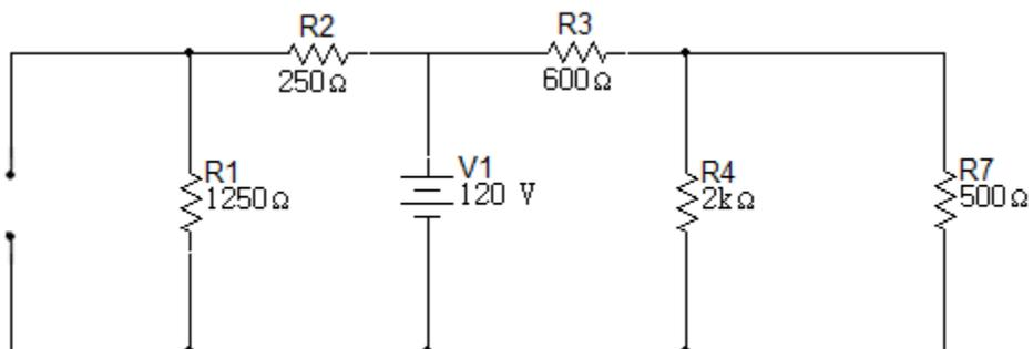
La siguiente reducción será el paralelo de las resistencias  $R_4$  y  $R_7$ .
