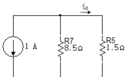
La última transformación será la de la fuente de corriente en una fuente de tensión en serie con la resistencia de  $8.5\Omega$ :
