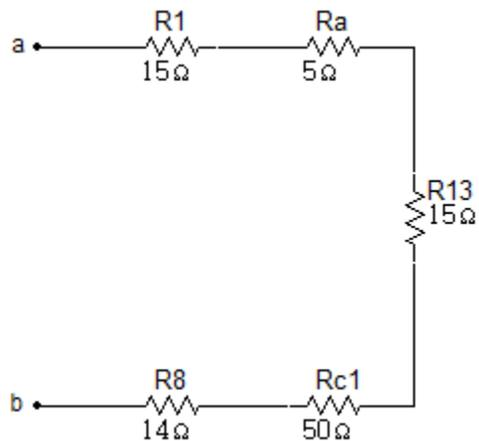
La última reducción será la serie de las resistencias  $R_1, R_a, R_{13}, R_{c1}$  y  $R_8$ :
