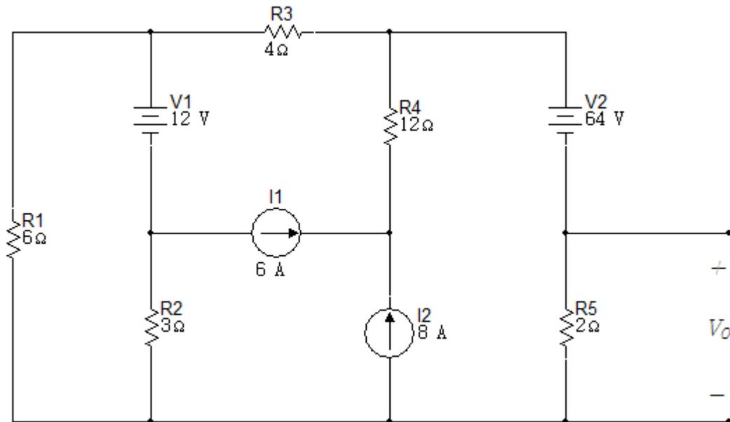
7. Encontrar  $V_0$  en el circuito de la figura 6.2.7 usando análisis de mallas.
