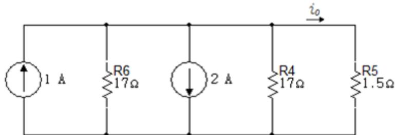
A continuación se hará la suma algebraica de las fuentes de corriente y la equivalente en paralelo de las resistencias de  $R_6$  y  $R_4$ .
