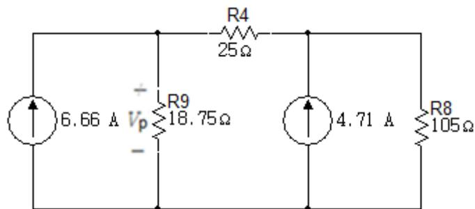
La siguiente transformación es la de la fuente de corriente de 4.71A en una fuente de tensión en serie con la resistencia de 105Ω.
