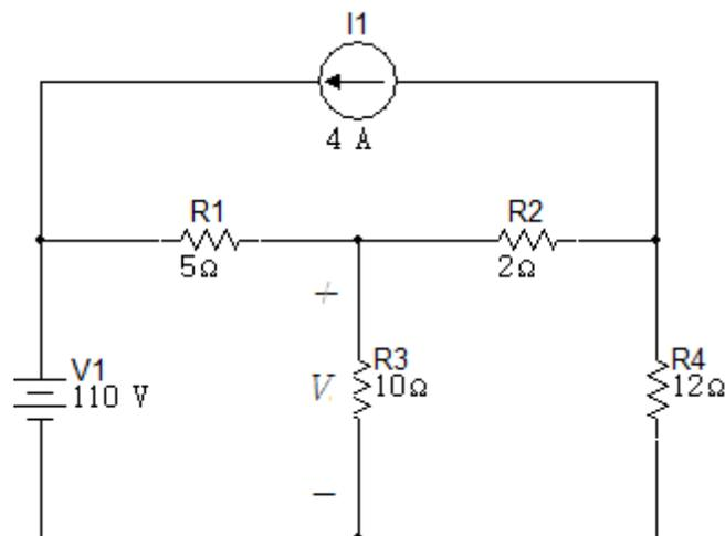
3. Use el principio de superposición para encontrar  $V_0$  e  $i_0$  en el circuito de la figura 6.3.3.
