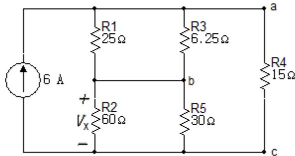
Para la obtención de la tensión  $V_x$  se reduce el circuito realizando el paralelo de las resistencias  $R_1$  y  $R_3$  y  $R_2$  y  $R_5$ .
