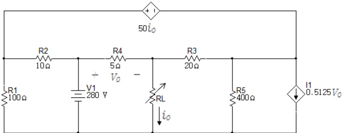
44. La resistencia variable en el circuito de la figura 6.3.45 es ajustada para la máxima transferencia de potencia de  $R_0$ .
