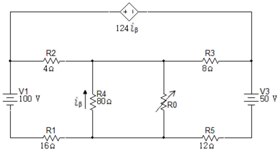
45. Encuentre el valor de  $R_L$  para máxima transferencia de potencia en el circuito de la figura 6.3.46 y determine la máxima potencia.
