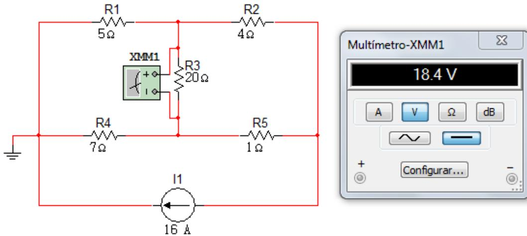
Teniendo el valor de  $V_{01}$ ,  $V_{02}$  y  $V_{03}$  con cada una de las fuentes actuando solas, tenemos el valor total de  $V_0$ .
