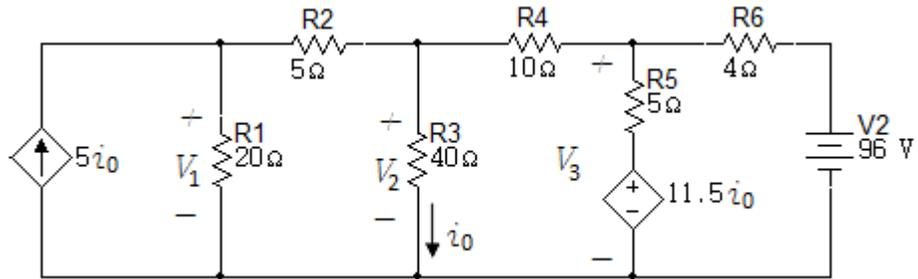
28. Use el método de tensiones de nodo para encontrar  $i_0$  en el circuito de la figura 6.2.28.
