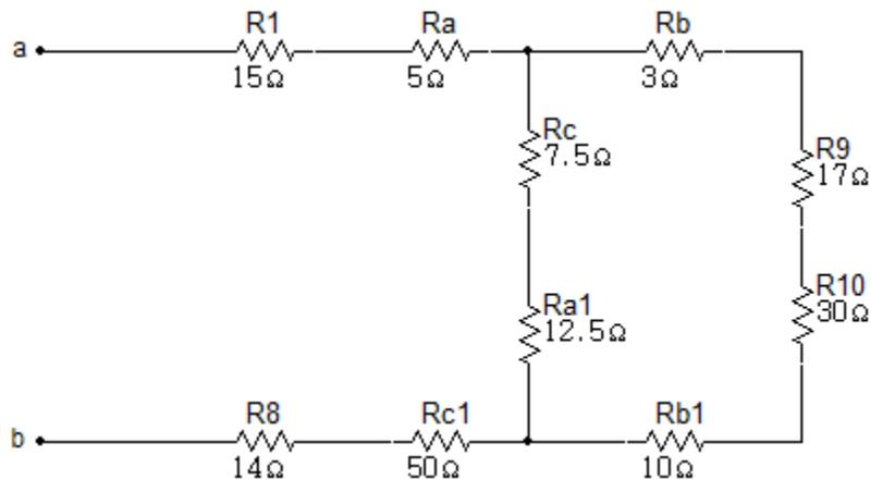
Para la reducción del circuito se realiza la serie de las resistencias  $R_b, R_9, R_{10}$  y  $R_{b1}$ :
