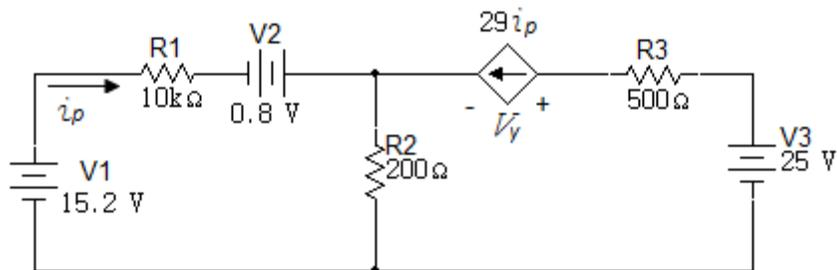
70. Para el circuito mostrado en la figura 6.1.53 calcule:
