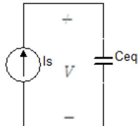
A través de los capacitores existe la misma tensión  $v$ . Al aplicar LKC a la figura 5.29.
