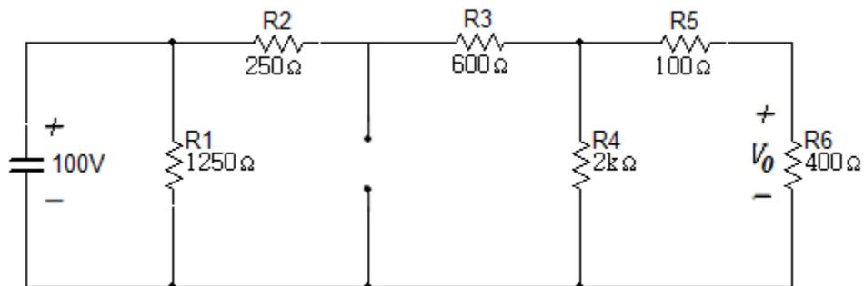
Para simplificar el circuito se realiza la serie de las resistencias  $R_5$  y  $R_6$ .
