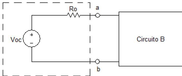
Para obtener la tensión  $V_{oc}$ , denominado tensión a circuito abierto, separamos el circuito B del circuito A y determinamos la tensión entre los nodos a y b. (Figura 4.91)
