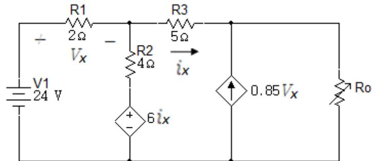
41. La resistencia variable ( $R_L$ ) en el circuito de la figura 6.3.42 está ajustada para absorber la máxima potencia transferida a  $R_L$ .
