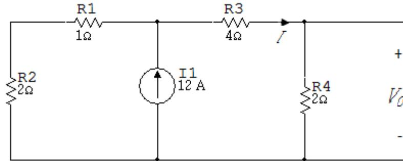
45. Encontrar  $V_0$  en el circuito de la figura 6.1.28 si  $I_1 = 6\text{ A}$ .
