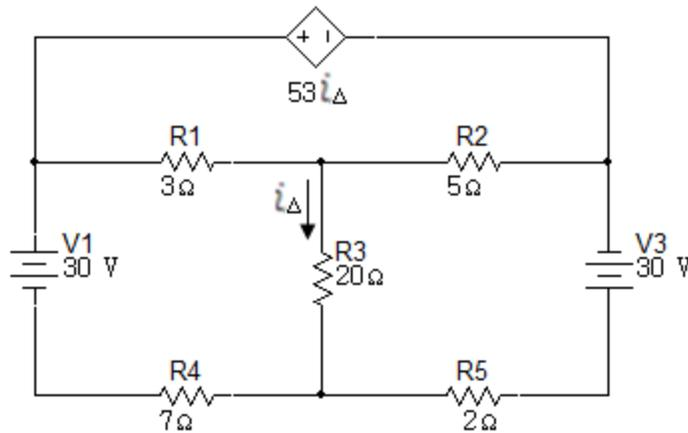
13. Use el método de corrientes de malla para verificar el equilibrio de potencia del circuito de la figura 6.2.13.
