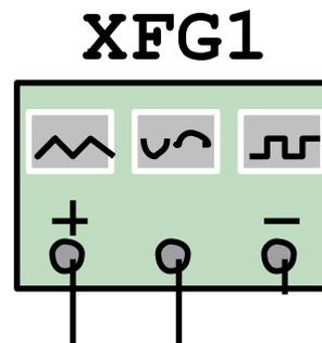
El Generador de Onda se debe configurar según la forma de onda, frecuencia y amplitud que se desee tener a la entrada.
