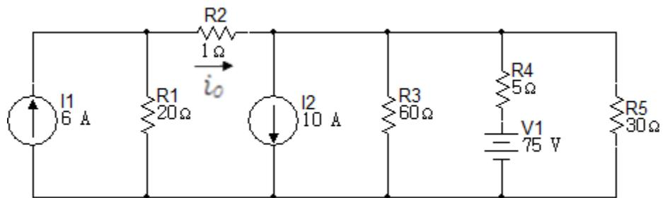
11. Use una serie de transformaciones de fuentes para encontrar la corriente  $i_0$  en el circuito de la figura 6.3.11. Verifique la respuesta usando el método de tensiones de nodos para encontrar  $i_0$ .
