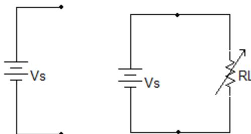
Una fuente de tensión CD de  $1V$  produce una corriente de  $1A$  a través de una resistencia de  $1\Omega$  y una corriente de  $1.00.000A$  a través de una resistencia de  $1\mu\Omega$ ; es decir, tiene una capacidad limitada para entregar potencia. En la realidad no existe un dispositivo así, y por lo tanto una fuente práctica de tensión debe modificarse para tener en cuenta la disminución de tensión entre sus terminales cuando se extraen grandes corrientes de ella.
