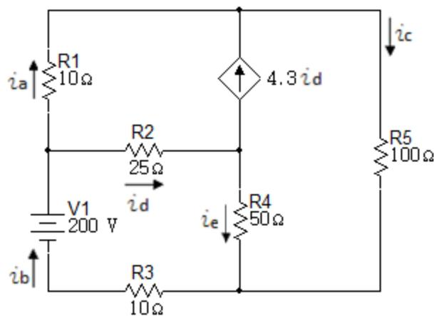
17. Usando el método de tensiones de nodo encontrar  $i_o$  en el circuito de la figura 6.2.17.
