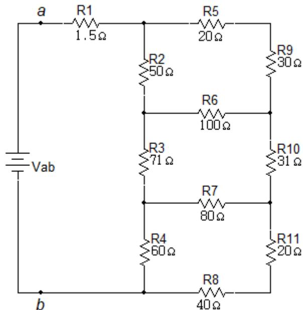
82. Utilice una transformación  $Y - \Delta$  para calcular:
