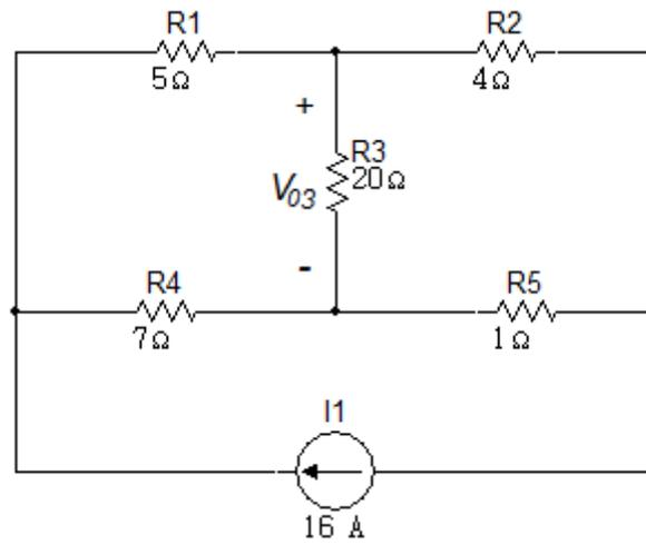
Para este caso se hará uso de las Corrientes de Malla para obtener la tensión  $V_{03}$ .
