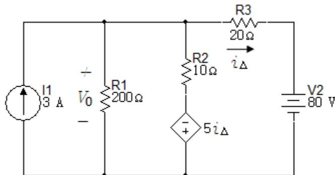
27. Encontrar las tensiones de nodo  $V_1, V_2$  y  $V_3$  en el circuito de la figura 6.2.27 y encuentre la potencia total disipada en el circuito.
