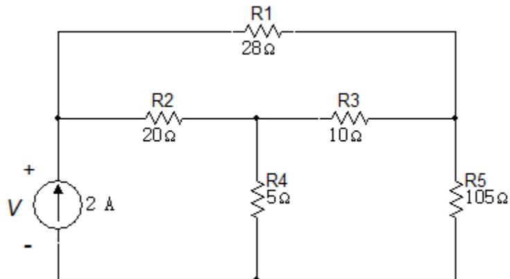
78. Utilice transformaciones de fuentes  $Y - \Delta$  y  $\Delta - Y$  para calcular  $R_{ent}$  para la red del circuito de la figura 6.1.61.
