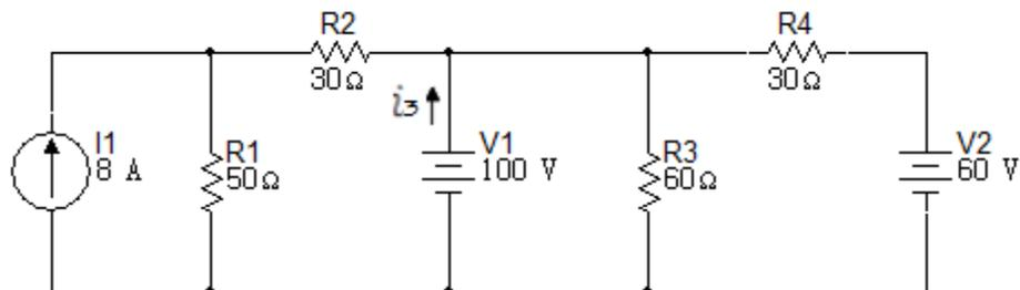
9. Use el principio de superposición para hallar  $i_o$  y  $V_o$  en el circuito de la figura 6.3.9.
