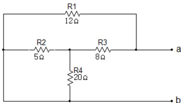
Para hallar la  $R_{Th}$  se debe realizar el paralelo de las resistencias  $R_2$  y  $R_4$ .
