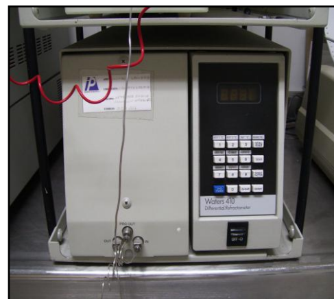
Fig 31. Detector de índice de refracción para columna cromatográfica a. Pincipio del detector. b. Aspecto general
