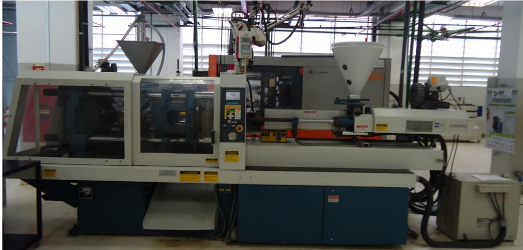
Figura 2.10 – Injetora da marca ROMI utilizada na preparação dos corpos de prova.
