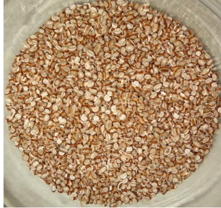
Figura 2.8 – Grãos de biocompósitos de PP com fibras de curauá homogeneizados.
