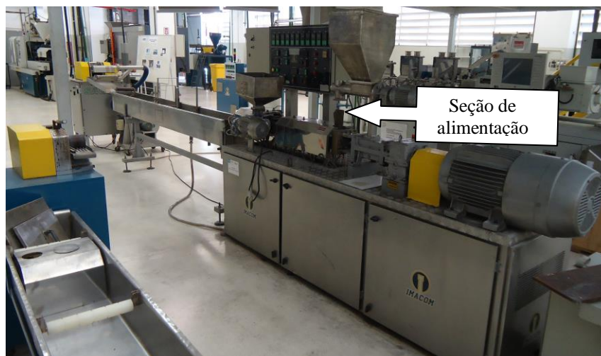
Figura 2.4 – Extrusora utilizada na obtenção dos biocompósitos.
