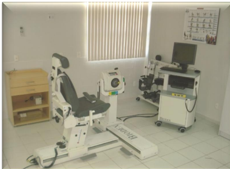
Figura 4 – Sistema de dinamometria isocinética utilizado no experimento (modelo Multi-joint System 4 Pro da marca Biodex).
