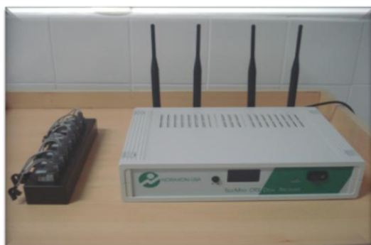
Figura 2 – Conversor analógico/digital e transmissores wireless utilizados no estudo
