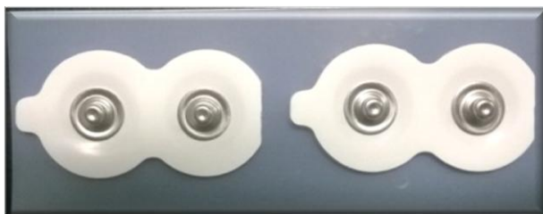
Figura 3 – Adesivos para eletrodos de superfície simples diferenciais utilizados na pesquisa.
