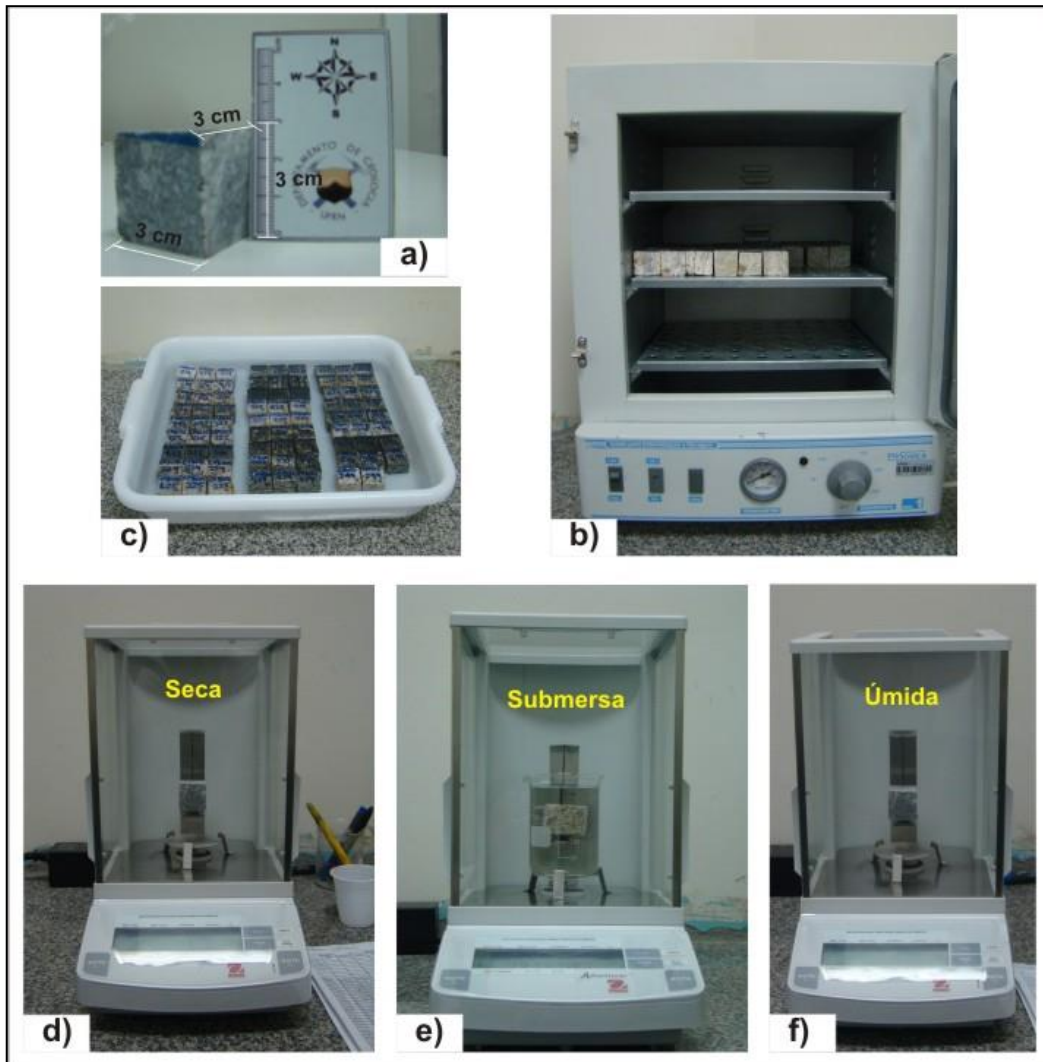
Figura 2.14- Equipamentos utilizados para se obter o valor de densidade: a) Amostra em formato de cubo; b) Estufa utilizada para secagem das amostras; c) Amostras para a pesagem submersa e saturada (úmida); d) Pesagem seca, e) Pesagem submersa e f) Pesagem saturada (úmida). Compilado de Oliveira (2011).
