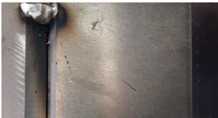
**Figura 9.** Ponto de solda em uma das extremidades dos corpos de prova
