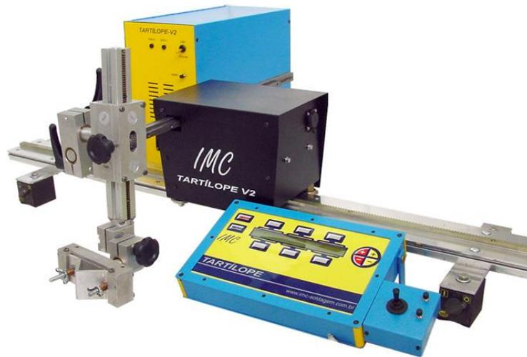
**Figura 13.** Mecanismo de deslocamento uniforme da tocha (LABSOLDA, 2013)
