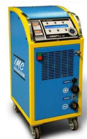
**Figura 11.** Fonte de soldagem (IMC, 2012)
