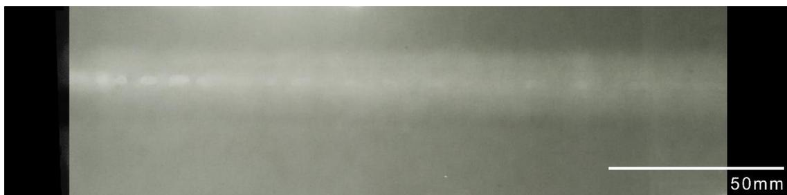
**Figura 37.** Radiografias dos cordões de solda com o arame ER5087 utilizando a técnica MIG-P CC+
