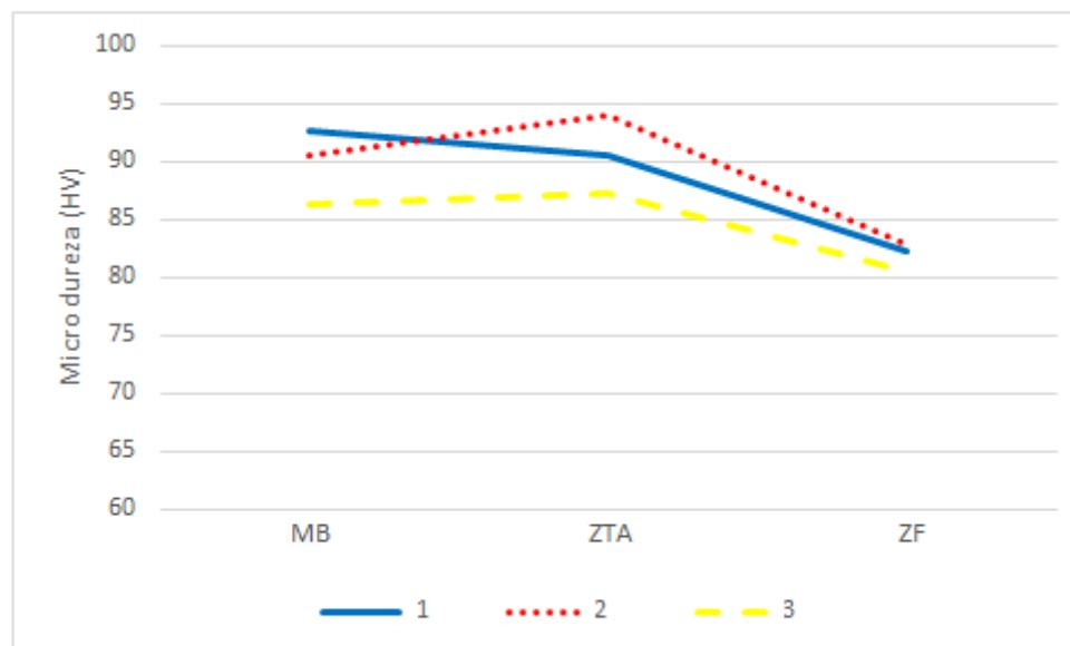
**Figura 50.** Microdureza obtida na chapa de 12 mm com a técnica MIG-P CC+
