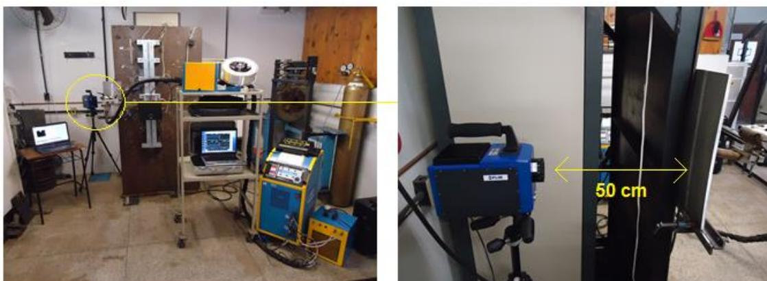
**Figura 17.** Bancada de soldagem com a câmera térmica
