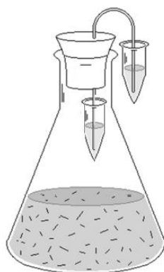
Figura 3.3. Frasco Erlenmeyer adaptado para fermentação de etanol celulósico
