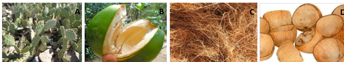
Figura 3.1. Materiais lignocelulósicos: (A) Cacto; (B) Casca de coco verde; (C) Fibra de coco maduro; (D) Casca de coco maduro
