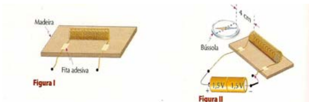
Figura 36 – Esquema de uma bobina
