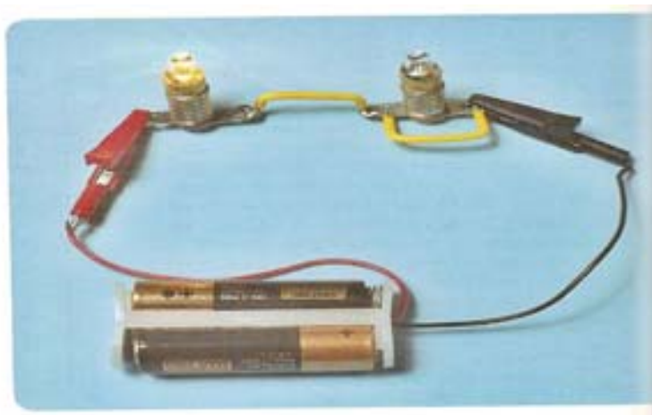
Figura 33 – Esquema de um circuito elétrico em curto.
