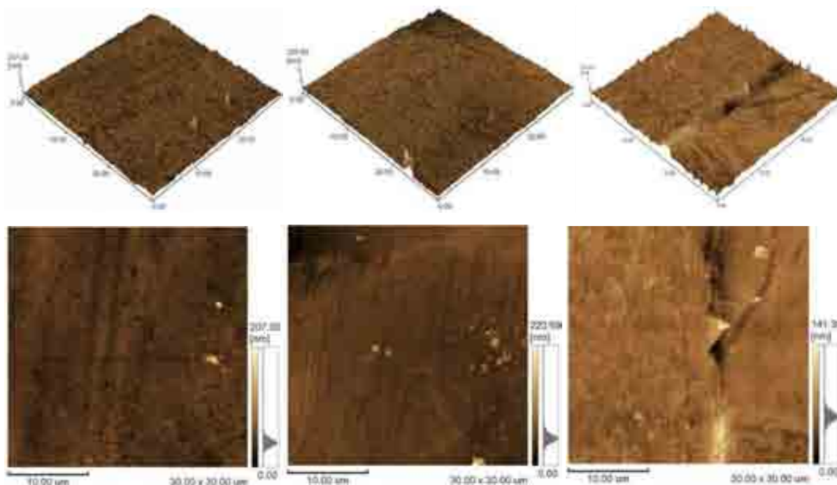
Figura 83 – Superfície lubrificada com B100-G n°6: (a) centro, (b) borda frontal e (c) borda lateral
