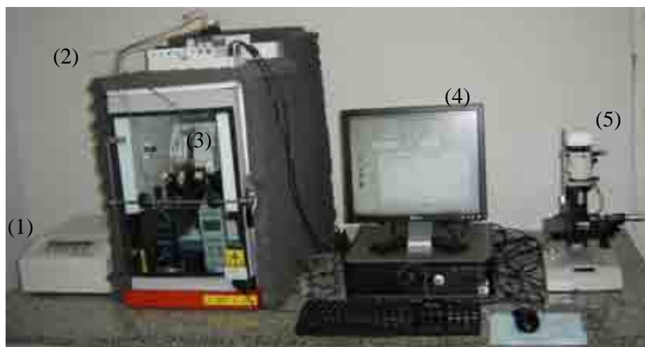
Figura 29 – Bancada HFRR para avaliação de lubrificidade de combustíveis
