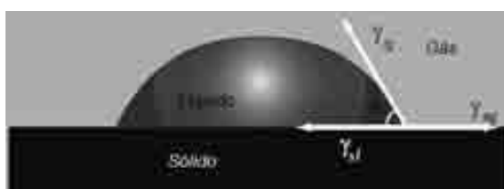
Figura 3 – Representação esquemática do ângulo de contato formado
