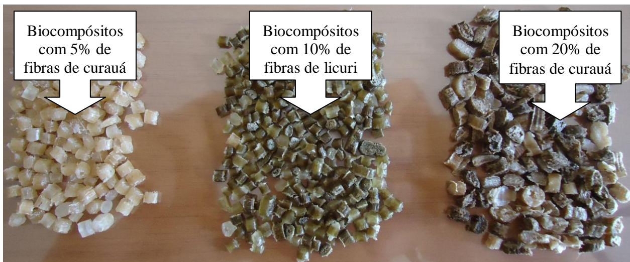
Figura 2.9 – Biocompósitos granulados utilizados para preparação dos corpos de prova na Injetora ROMI
