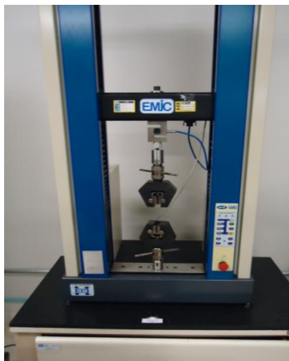
Figura 2.14 – Máquina universal de ensaios, tração – EMIC
