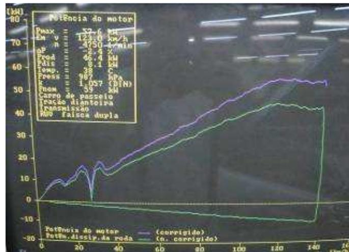
O gráfico da Figura 5.5 mostra o resultado do ensaio realizado com o GNV. A curva começa a cair quando o motor atinge a potência de 52,9 kW. A curva de potência mostra que o motor consegue uma potência maior a uma velocidade de 125,5 km/h, a uma rotação de 4860 rpm em quarta marcha.
