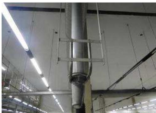
O manual do fabricante do dinamômetro recomenda colocar um dispositivo de aspiração no cano de escape a uma distância de aproximadamente 20 cm. Dessa forma impede-se que haja uma variação de pressão devida ao processo de aspiração. Para atender a esta recomendação foi desenvolvido pela equipe técnica um adaptador para o sistema. A Figura 4.21 mostra uma foto do adaptador interligado ao sistema de exaustão do Laboratório automotivo do CTGAS-ER.
