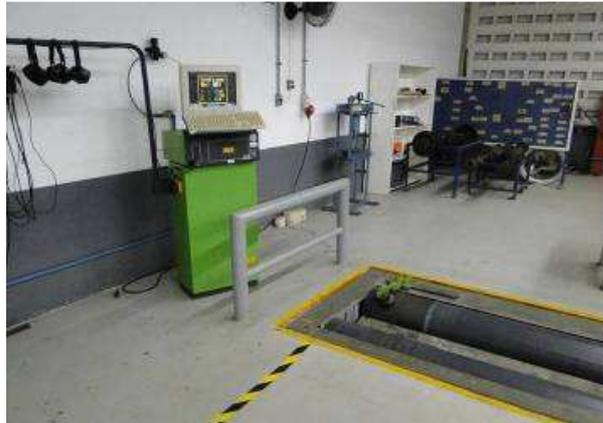
O dinamômetro de chassi, além de medir potência do motor, tem outras funções como: medir potência da roda, força de tração, simulação de rodagem, percurso e controle do tacômetro, como mostra a Figura 4.14.
