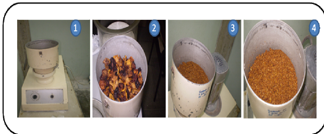
Figura 3.4. Moinho de faca e farinha produzida.
