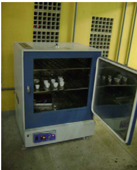
Figura 3.6. Estufa utilizada para a determinação da umidade do caju após seco.
