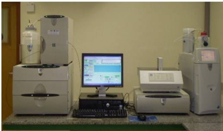
Figura. 3.9. Cromatógrafo de íons utilizado para a determinação de cinzas.
