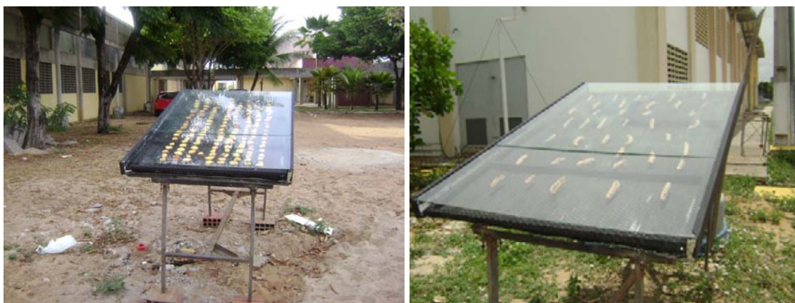
Figura 3.3. Secador solar construído em teste.
