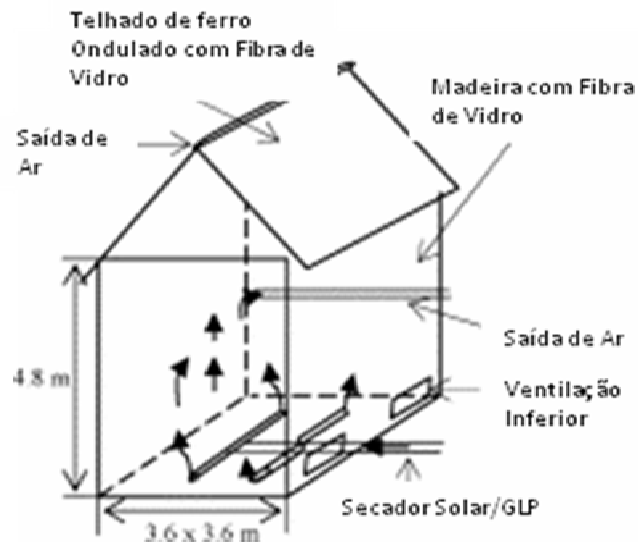
Figura 2.18. Protótipo de um secador híbrido com GLP (Ssopouronnarit,1995).
