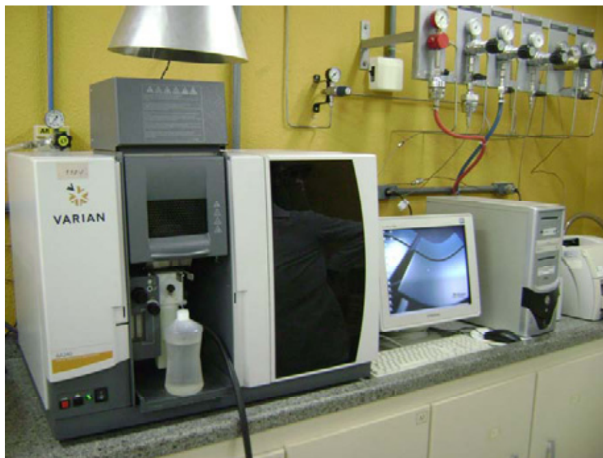
Figura 3.8. Espectrofotômetro de absorção atômica utilizado para a determinação dos minerais.
