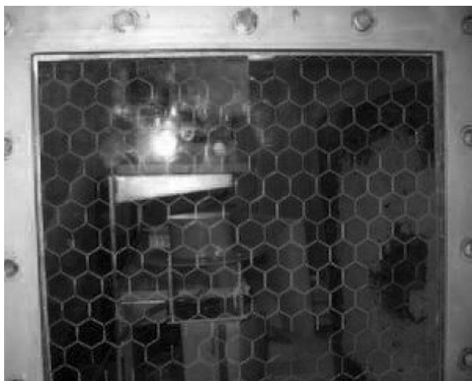
Fig. 2.7. Imagem de uma janela seletiva de frequência.
