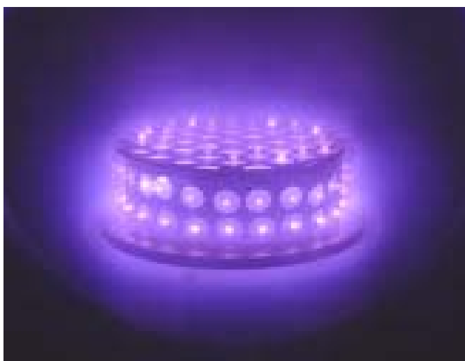
Figura 2.11 - Aspecto visual da formação do plasma na superfície da gaiola apresentando o efeito catodo oco nos furos.
