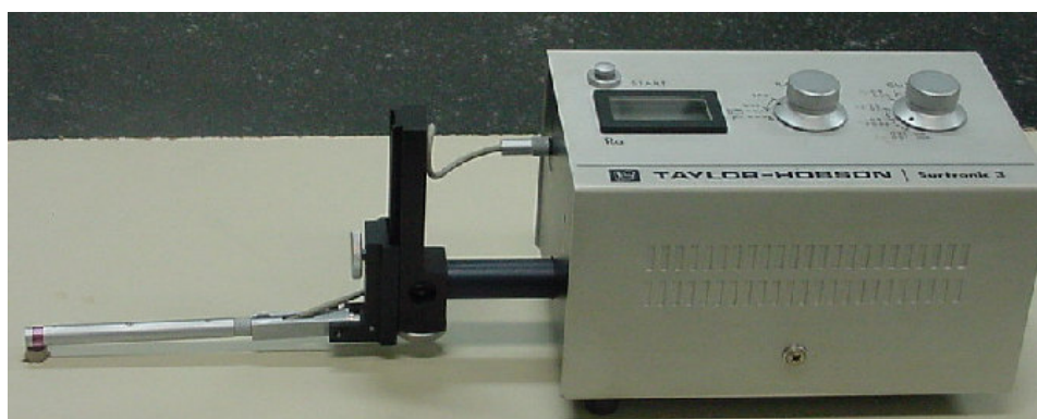
Figura 3.8 – Aspecto visual da obtenção da medida de rugosidade na amostra executada pelo rugosímetro.
