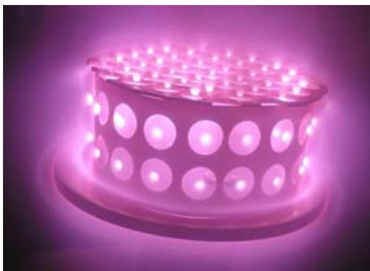
Figura 4.12 – Nitretação em Gaiola Catódica, evidenciando o efeito catodo oco formado nos furos da gaiola.
