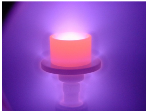
Figura 8. Efeito de cátodo oco em um cilindro, para descarga dc.
