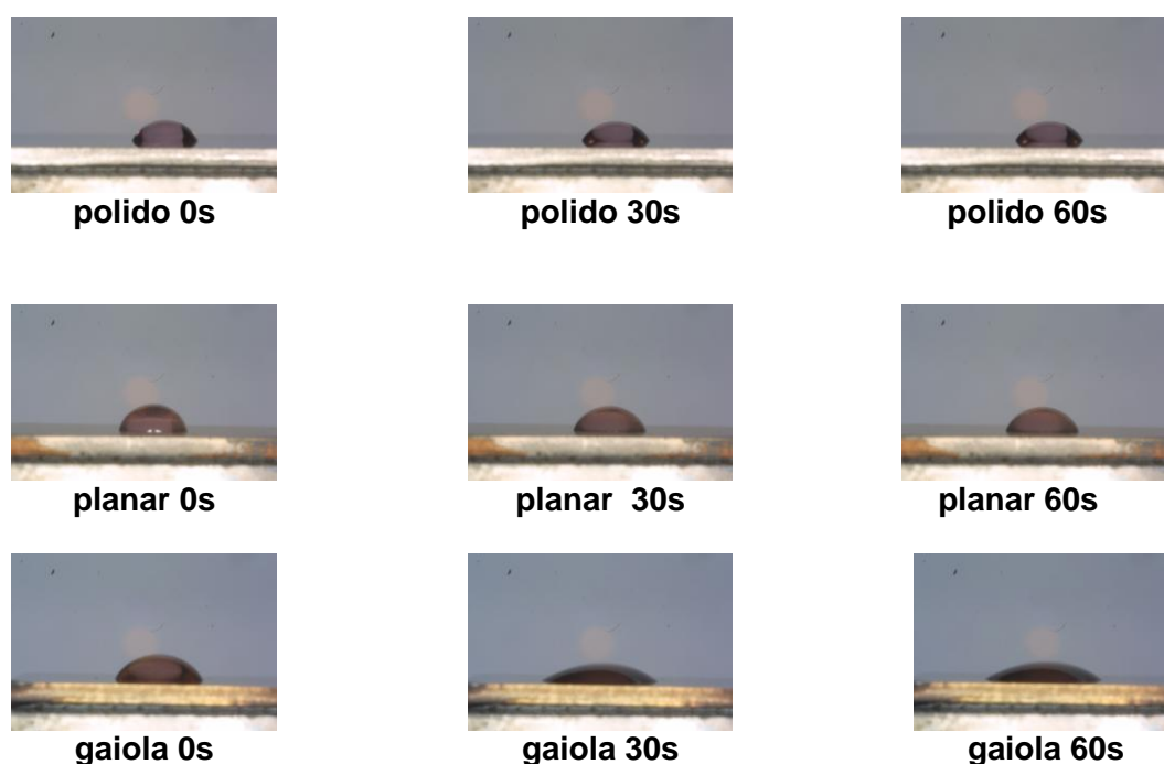
Figura 11 - Ângulo de contato nas diferentes superfícies do titânio
