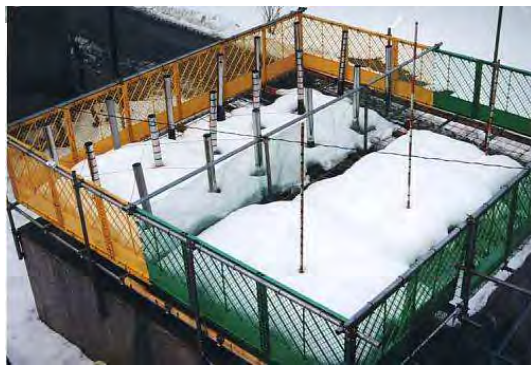
図 2-25 筒の周りとフェンス付近の雪が更に融け後退している様子 H12.2. 3
