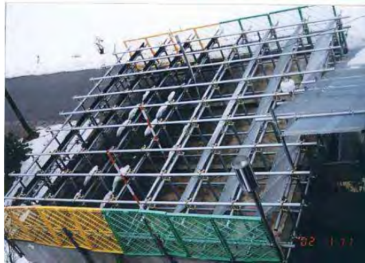
図 2-59 北側のI鉄パイプ 部分が完全消雪した様子 地上 28cm H14.1.11
