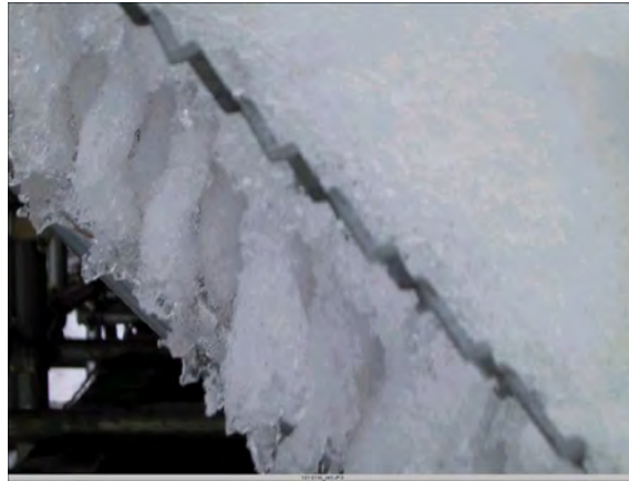
図 1-33 エキスパンドメタルを 45° 傾斜させて行った実験 エキスパンドメタルから新雪が垂れ下がった様子 H14.2.16
