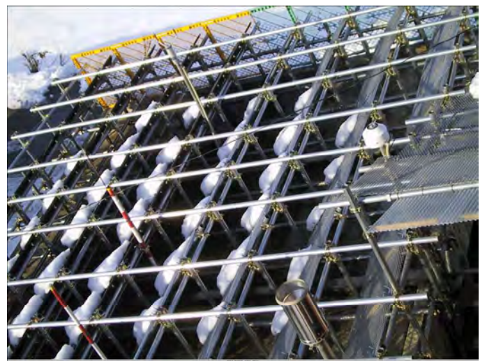
写真8 45°の融雪板上の積雪の様子H14.2.21
