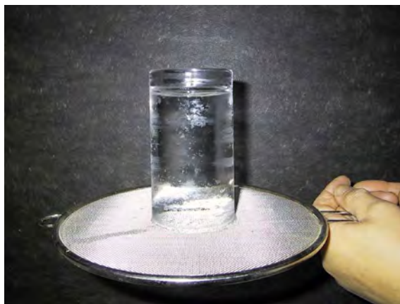
図 1-23 表面張力の働きのために逆さにしたコップの水が金網から抜けずに残る様子
