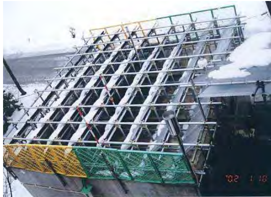
図 2-58 北側のI鉄パイプ 3 列目も露出し始めた様子 地上 33cm H14.1.10
