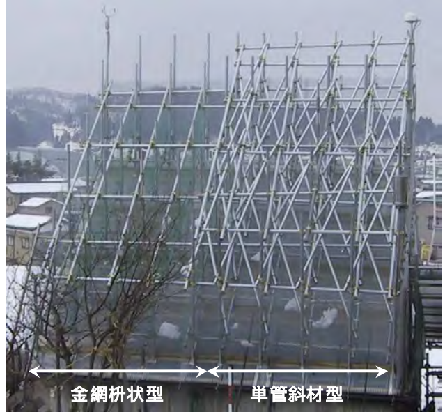
図 1: 45°勾配二重屋根式通気融雪工法
