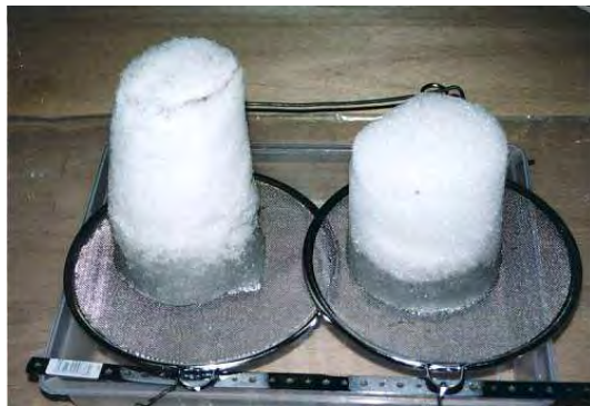
図 1-27 左側のしまり雪の変態が右側のざらめ雪よりも進んでいる様子 13:00 吸い上げ高さはしまり雪は 5cm、ざらめ雪は 3cm
