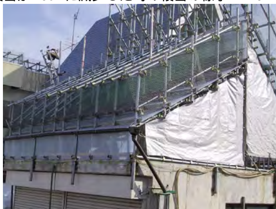
図 5-25 地上の積雪が 49cm に減少した時に完全消雪した様子 H16.2.21 於栃尾市原町
