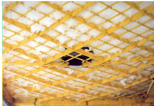
図 2-41 上の雪塊がプラスチックの目から少し融けて垂れ下がっている様子 H12.2.20
