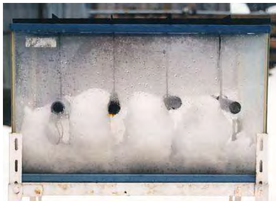
図 2-5 雪が降り止みパイプが露出し空洞が拡大している様子 H9.2.24
