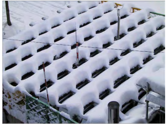
写真7 45°の融雪板上の積雪の様子H14.2.11
