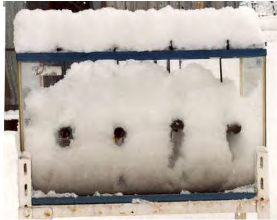
図 2-3 更に雪が降り積もりパイプが埋もれ空洞が変化している様子 H9.2.22
