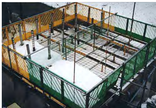
図 2-21 東側だけに雪が積もり、中央と西側は落下している様子 H12.1.24
