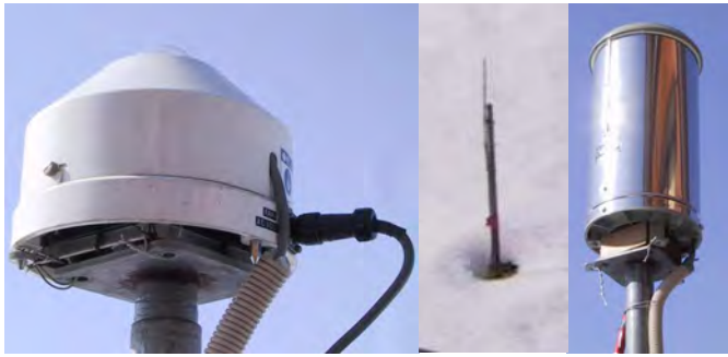
写真2 全天候型日射計(左上) 写真3 温度計測用熱電対(中央)
