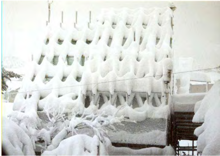
図 3-6 地上積雪が 50cm になった平成 15 年 1 月 5 日の様子「付着期」
