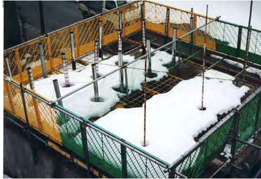
図 2-26 筒の周りとフェンス付近の雪が更に融け後退している様子 H12.2.7
