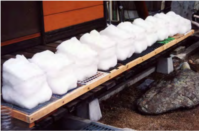
写真1 各種メッシュ材に雪を載せた様子H11.3.7.12:24
