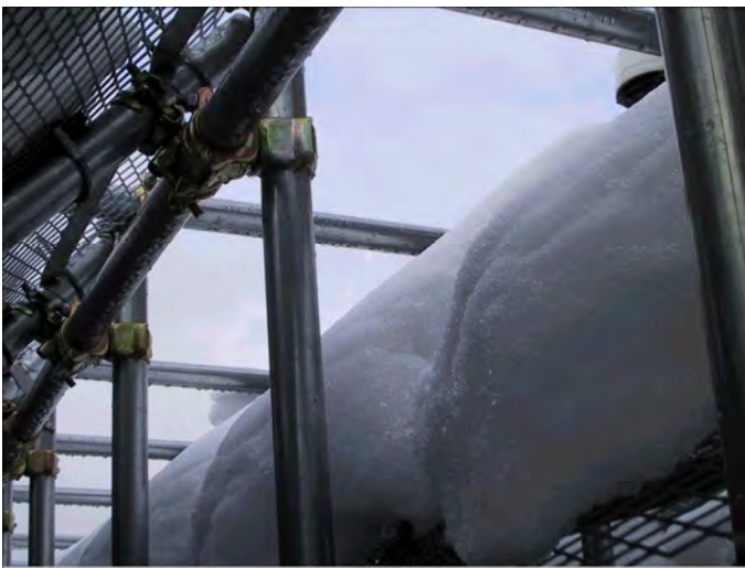
写真10 45°の融雪板頭繋ぎに伴う融雪の様子H14.2.20 3-4 単管パイプのグリッド配置による雪割り効果実験
