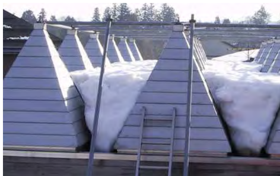
図 5-7 地上の積雪が 105cm の時の積雪の様子 H12.2.23 於栃尾市原町
