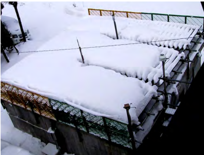
写真6 30°45°60°の融雪板上の積雪の様子H13.1.12
