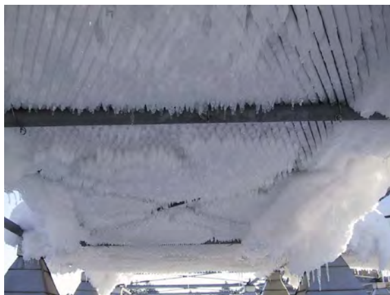
図 1-32 158cm 高さのピラミッド型屋根の上にエキスパンドメタルを水平に固定した実験 再凍結した雪の房が融けるのに時間がかかった 栃尾市原町 H16.2.11
