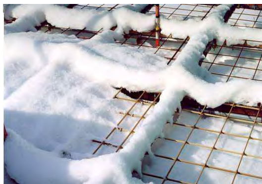
図 2-37 15cm と目が粗いため下の空洞が塞がり雪露出している様子 H12.2.26
