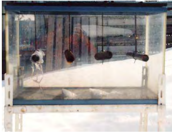
図 2-7 水槽内部の雪が殆ど融け、水槽の下に大きな空洞が発生している様子 H9.2.26
