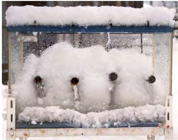
図 2-4 雪が少し降っているがパイプの下の空洞が拡大している様子 H9.2.23
