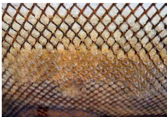
図 1-31 約 50cm 程度浮かしエキスパンドメタルを水平に固定した実験 融雪水が抜けずに再凍結してしまった 栃尾市原町 H12.2.27
