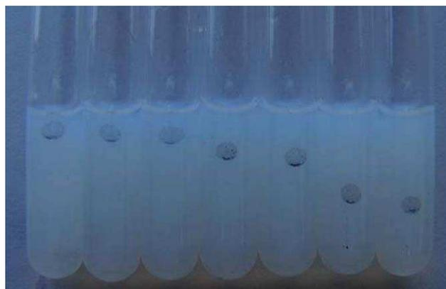
Figura II.11. Foto de los geles sintetizados para evaluar el tiempo característico de difusión de citrato en función de la distancia entre la superficie del monolito de sílica hasta la esfera de alginato. Se inmovilizaron en el alginato de calcio micropartículas de  $\text{CoFe}_2\text{O}_4$ , cuya movilidad frente a un campo magnético externo fue indicio de la licuefacción de la cavidad de alginato.
