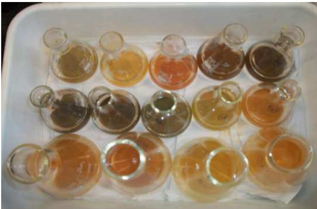
Figura 8.6 Erlenmeyers conteniendo las suspensiones de sólidos adsorbidos
