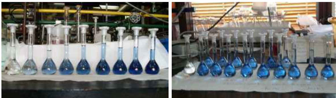
Figura 8.5 Ejemplos de la utilización del método de azul de molibdeno
