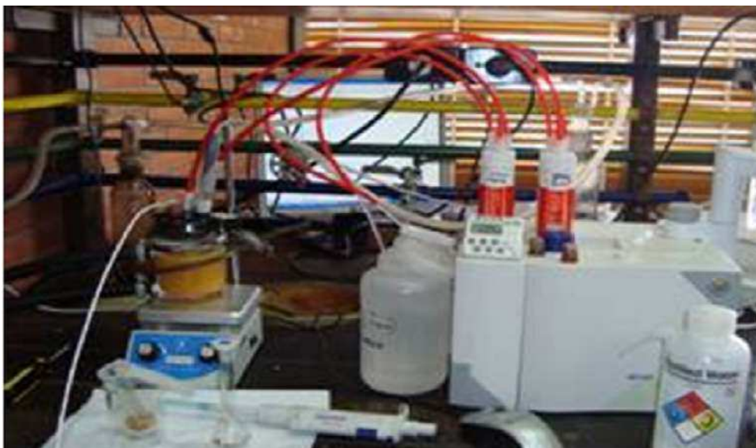
Figura 8.4 Sistema modelo utilizado para realizar las experiencias de disolución. En las disoluciones realizadas en oscuridad la celda de vidrio fue cubierta de la luz natural
