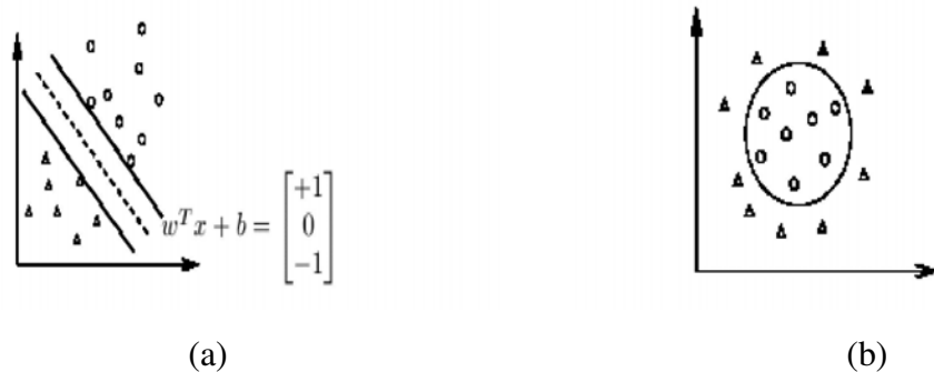
Figura 3.2: SVM (a) Datos linealmente separables con hiperplano; (b) Datos que no son linealmente separables [81]
