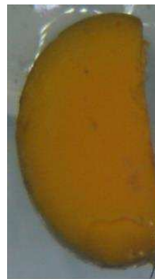
Figura 5.7 Aspecto del interior del catalizador B1 luego del ensayo realizado en ausencia de H 2 O 2 a T=323K.
