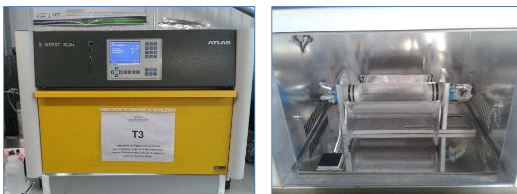
Figura 3.2. Simulador de radiación solar SUNTEST XLS + (ATLAS) equipado con un colector parabólico compuesto (CPC). Fotos del exterior e interior del equipo.
